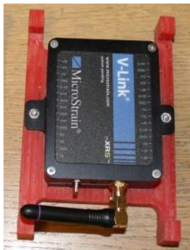
Figur 26: Ferdig brakett med V-Link
