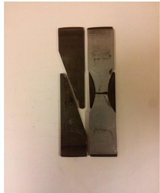
Figur 52: Utmattingsprøve med anti-knekkning-løsning
