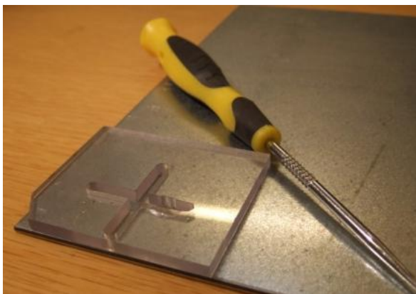
Figur 28: Mal for liming av strekkklapper
