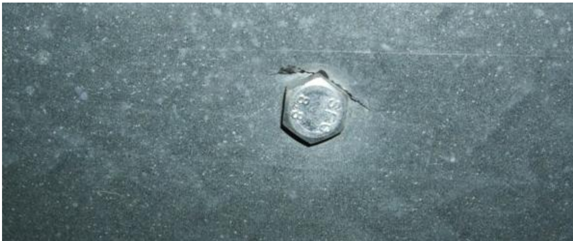
Figur 3: Illustrasjon av skade påført i testrigg
