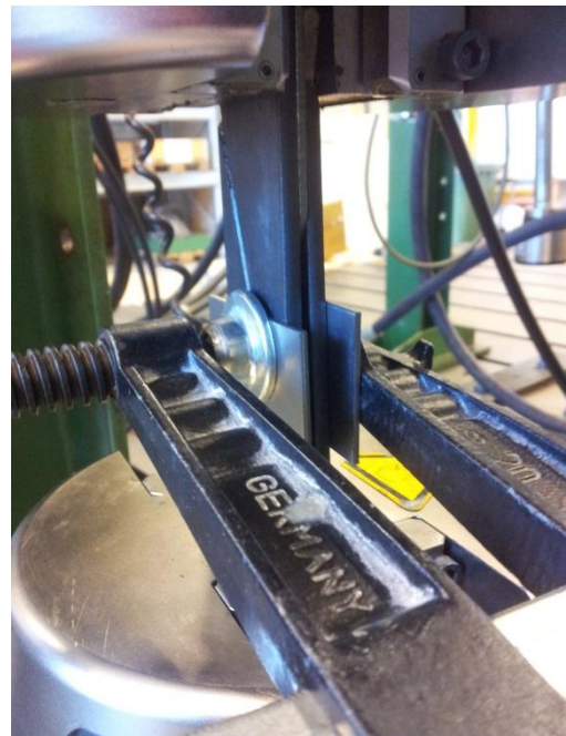
Figur 50: Prøve med anti-kneknings-løsning
