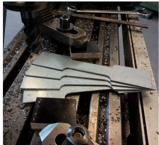
Figur 48: Testprøver ferdig maskinert
