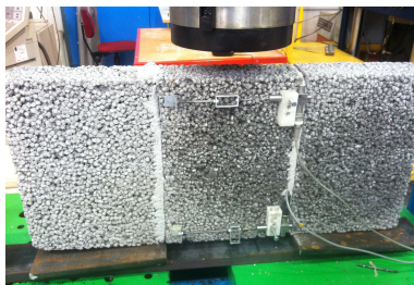
Figur 4.14: Prøvestykke av type 1 med lengdegivere.
