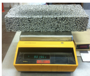
Figur 3.2: Veiting av en lettklinkerblokk.
