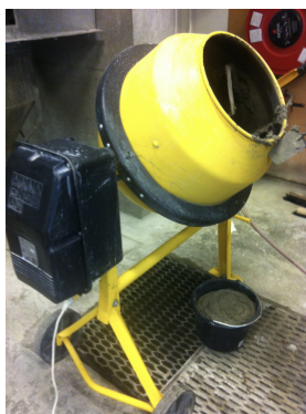
Figur 3.4: Blanding av mørtel.
