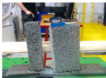
Figur 5.5: Bruddmekanisme i prøvestykke B4-B9.
