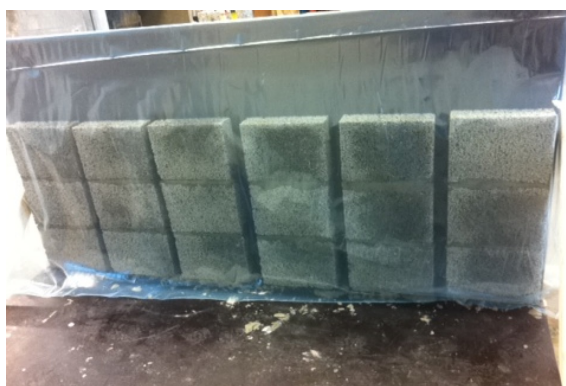
Figur 4.2: Rigg med ferdig oppmurte prøvestykker.
