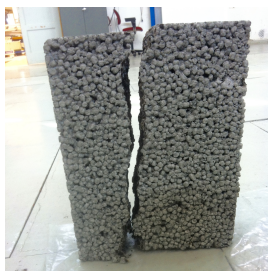
Figur 5.20: Bruddmekanisme i prøvestykker av ren lettklinker.
