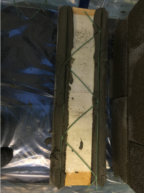
(a) Den ferdig kappede sikksakkarmeringen ble presset ned i mørtelen for å gi ordentlig heft.
