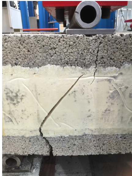
(d) Ved videre belastning forplantet bruddet i strekkvangen seg gjennom isolasjonen over i trykkvangen.
