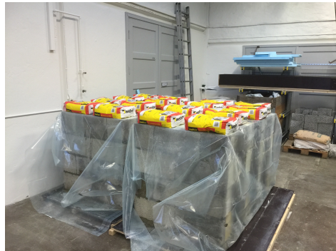
(d) Veggelementene ble satt til herding pakket inn i plast og belastet med to sekker med mørtel.
