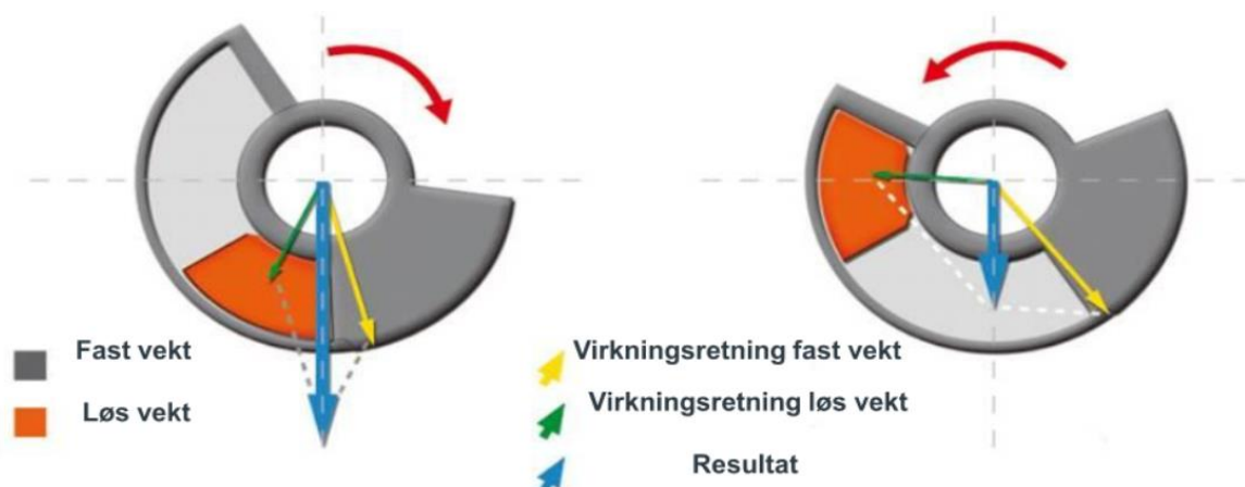
Figur 3: Justering av lodd på akselen i en vibrasjonstrommel. Illustrasjon: Wirtgen Norge
