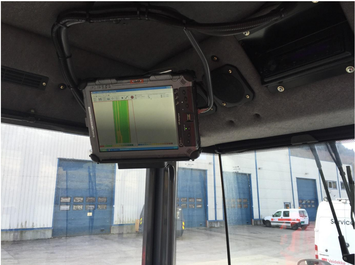
Foto 3: HCQ nettbrettet montert inne i HAMM valsen
