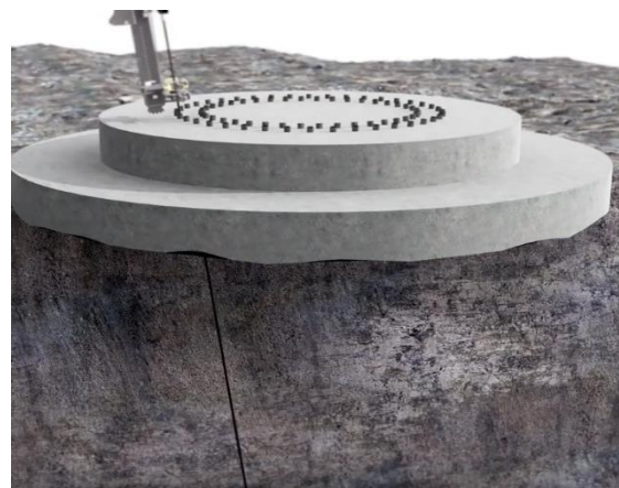
Figur 84 Boring av forankringsstag via fôringsrør (93)
