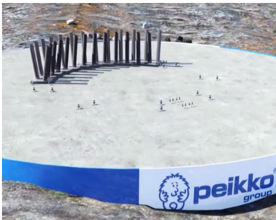
Figur 85 Vindmøllefundament. Skive med styringsrør for bor (93)
