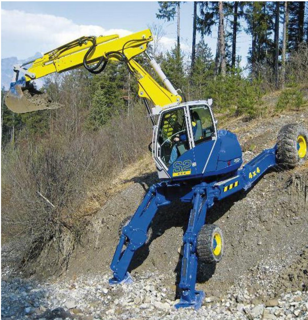
Figur 68 Bilde av gravemaskinen Kaiser S2 for ulendt terreng. (74)
