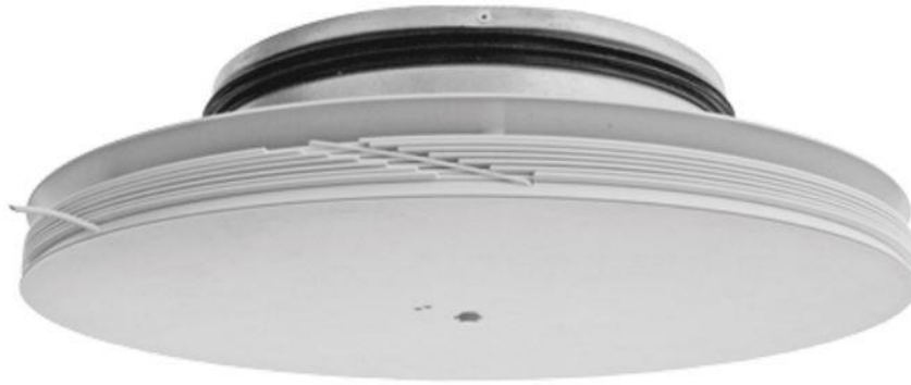
Figur 11 Aktivt tilluftsdon fra Lindinvent. Størrelsen mellom platene, spjeldhøyden, vil øke eller minke med luftmengdebehov i rommet for å oppnå konstant hastighet og kastelengde (Lindinvent, 2015d)
