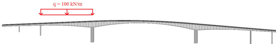
Figur 60 - Fiktivt lasttilfelle for å se på effekten av å halvere bøyestivheten i hovedpilarene.
