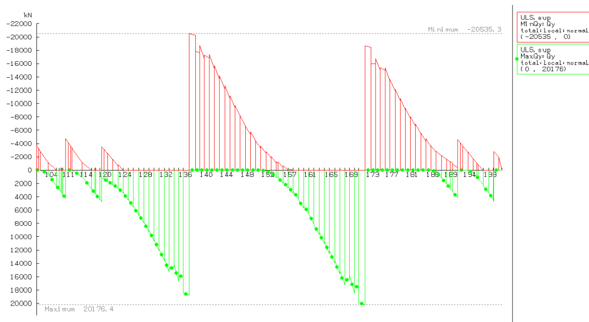
Figur 57 - Skjærkraftdiagram i bruddgrensetilstanden fra RM Bridge.
