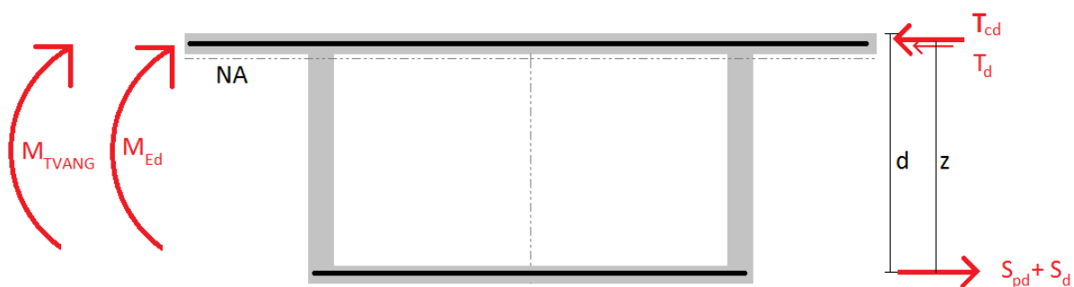
Figur 55 - Illustrasjon av ytre laster, indre krefter og tverrsnittets momentkapasitet i felt.
