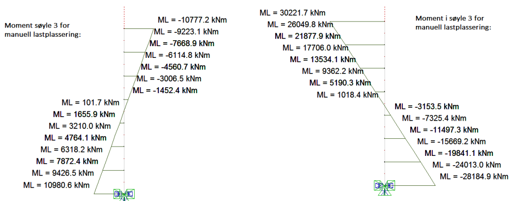
Figur 55: Viser resultatene fra den manuelt påsatte trafikklasten. Momentdiagram til venstre viser maks M, mens bildet til høyre viser min M i søyle 3.
