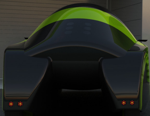
Med et mindre motorrom får man større muligheter til å minimere arealet bak på bilen.
