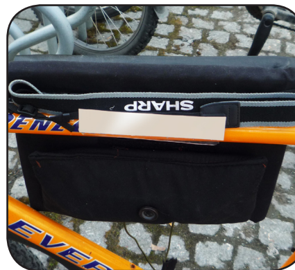
Forme opphenget slik at reima kan legges over og holdes på plass
