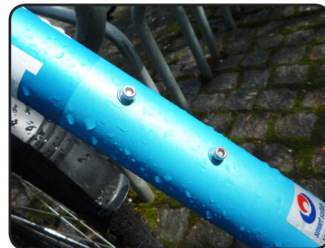
Standardhull på ramma til montering av flaskeholder
