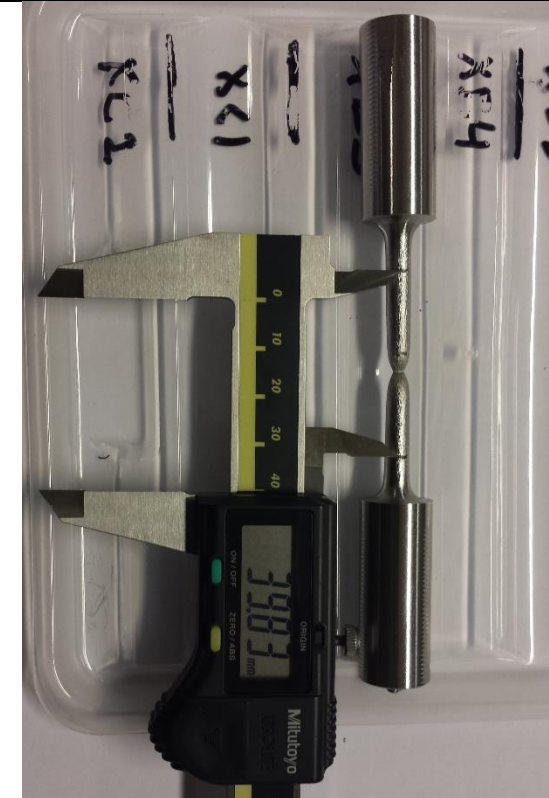
10. Prøvestykket ble plassert sammen slik at bruddflatene var i fullstendig kontakt. Dette gjorde det mulig å måle bruddforlengelsen til målelengden (til venstre) og kontraksjonen i bruddet (til høyre).
