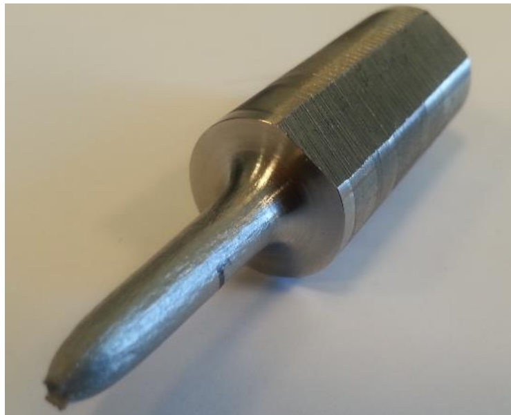
Figur 5-9: Eksempel på dimensjonalt avvik i gripeende.
