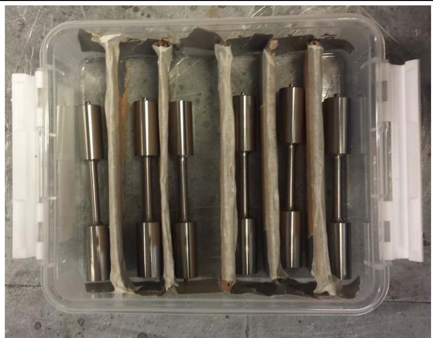
13. Resultatet etter at 7 av prøvestykkene var ferdig maskinert. Den merkede boksen med skillevegger, kombinert med markering på prøvestykkene, sørget for god sporbarhet og kontroll når strekkprøvene ble utført.
