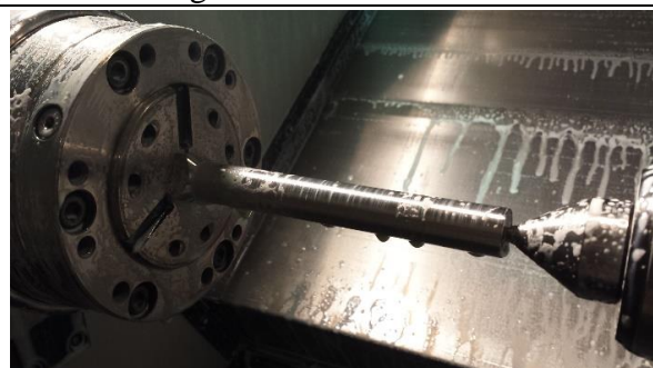
10. Seksjonstykkene ble først grovdreid, og videre findreid til et sirkulært tversnitt med diameter på 16 mm.
