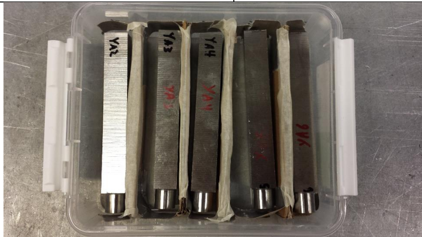
8. Hvert seksjonstykke ble plassert i en merket boks med skillevegger, slik at sporbarheten for hvert prøvestykke var sikret om/når den fysiske merkingen forsvant.
