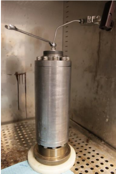
Figur 30 - Trykkbeholder lagt i varmeskapet
