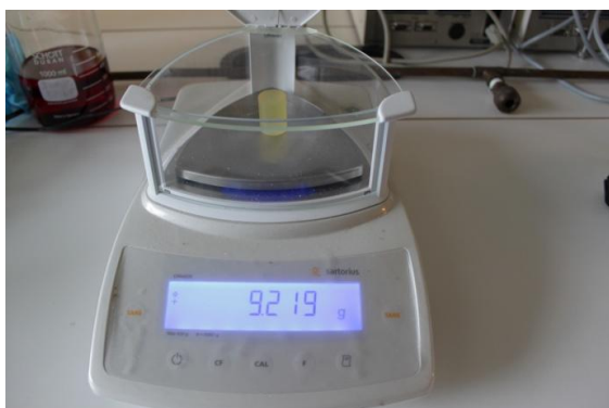
Figur 25 - Veiing av polyuretan
