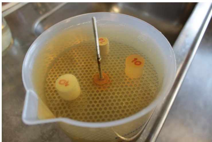
Figur 17 - Plastprøver nedsenket i vann
