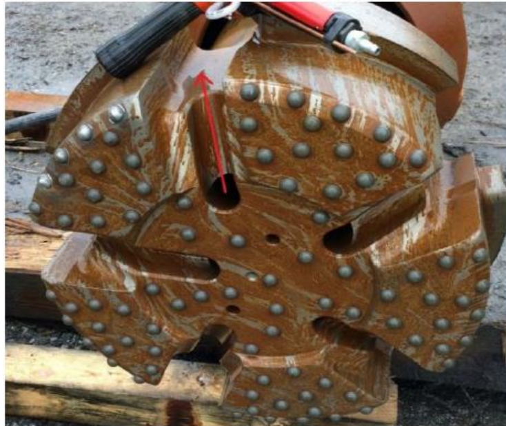
Figur 4-14: Borkrone benyttet under boringen, med angivelse av spylerettning (Hauge m.fl 2015)
