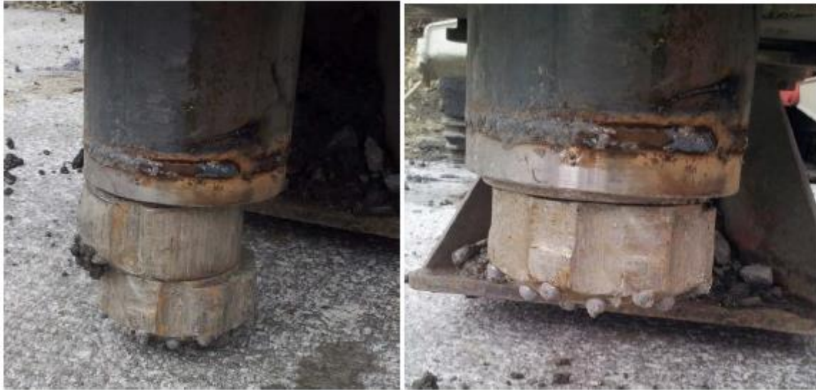
Figur 4-10: Venstre: Odex borkrone med eksentrisk rømmer og pilot. Høyre: Rømmer låst fast inne i foringsrør (Lande m.fl 2015)
