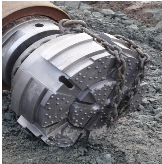
Figur 5-8: Radial flush borkrone benyttet under boringen (Foto Samson Degago)
