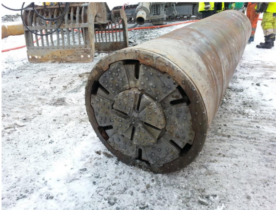
Figur 5-20: Borkrone koblet til ringborkrone (foto. Samson Degago)
