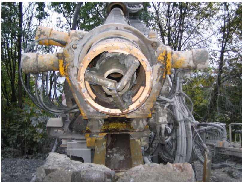
Figur 4-7: Borkrone benyttet ved første boring i Norge ved hjelp av RC-utstyr. Tricone krone (Hanson 2008)
