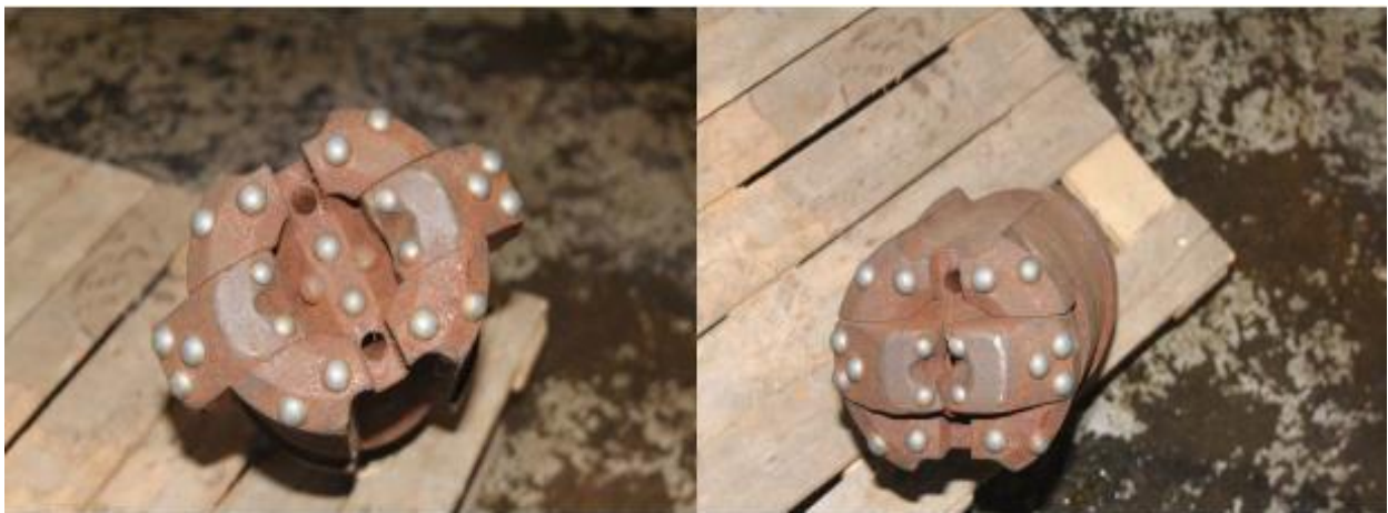
Figur 4-4: Vingeborkrone. Til venstre, vinger som er presset ut. Til høyre vinger slått inn. (Simonsen og Veslegård 2014)
