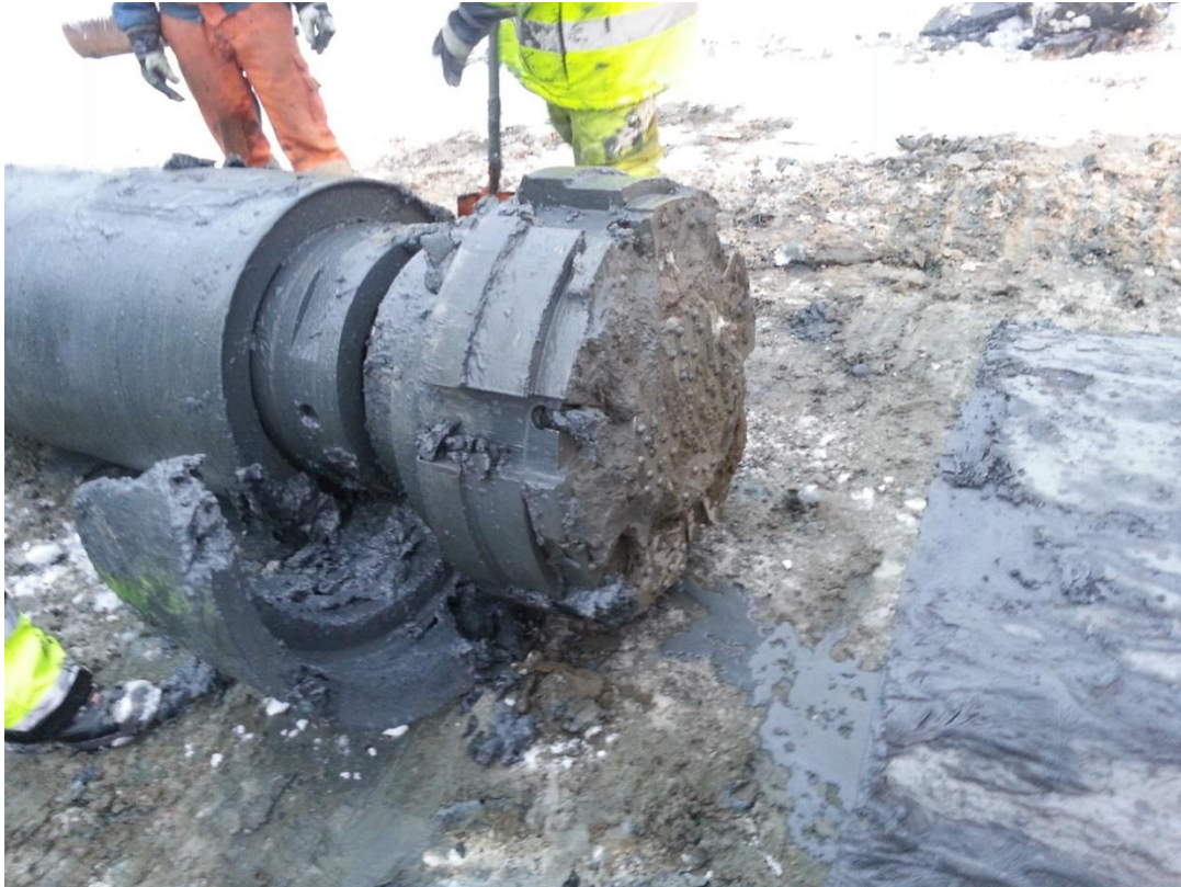
Figur 5-23: Massene i borkronen pakket seg sammen/frøs fast (foto Samson Degago)
