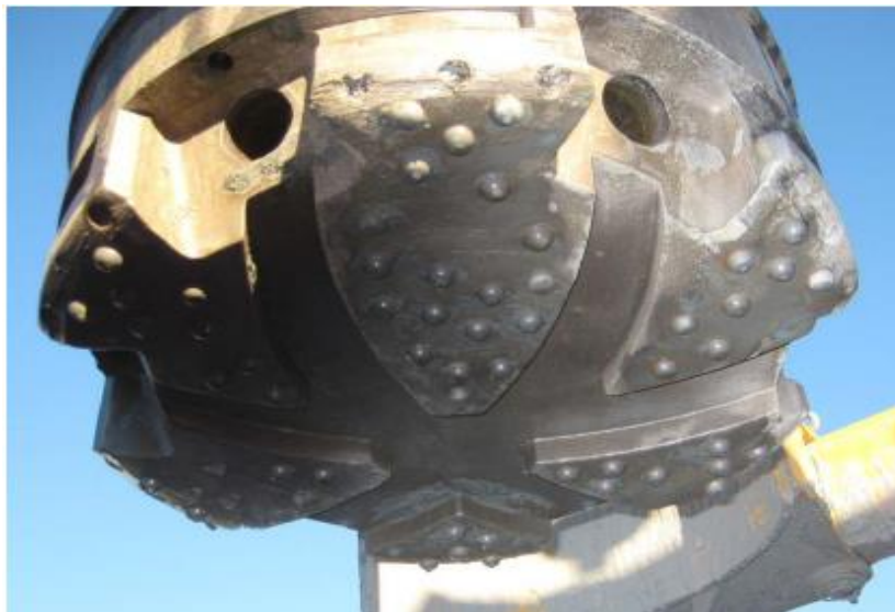
Figur: 4-12: Modifisert pilotkrone (Rønning 2011)
