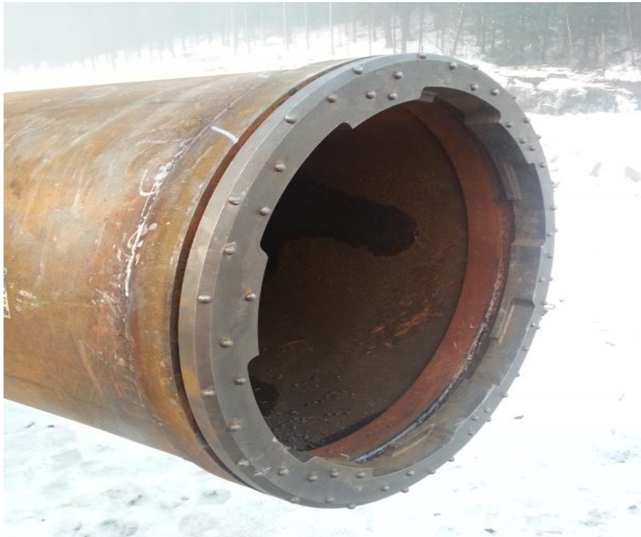
Figur 5-9: Ringborkrone og forstrekningsring sveiset til føringsrøret (Foto Henrik Tømmervik)
