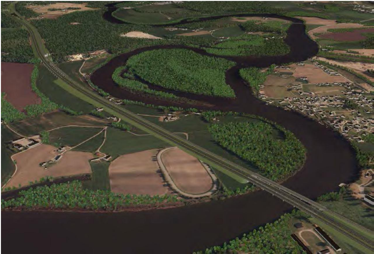
Figur 5 Modellutsnitt fra Forprosjekt rapporten (delstrekning 4, E16 og Ringeriksbanen) fra Jernbaneverket og Statens vegvesen. Fyllingen på Mælingen vil som prosjektert bli opp til 10 m høy (SVV og JBV, 2016).
