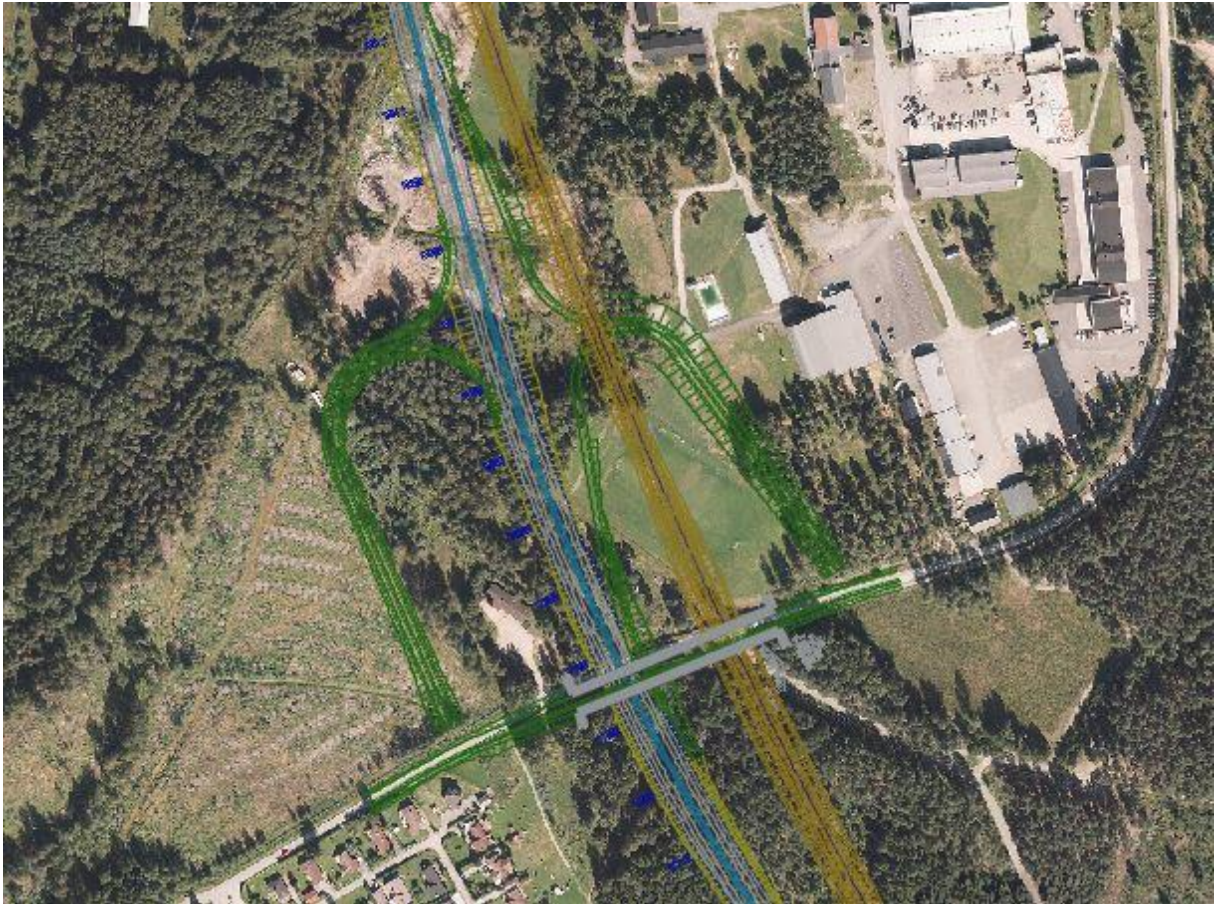
Figur 60 Oversiktsbilde over kryssområde ved Helgelandsmoen. Her er foreslått lavpunkt lokalisert og området er flomutsatt ved 200 års flom (Skjermdump fra prosjekteringsverktøyet Novapoint).
