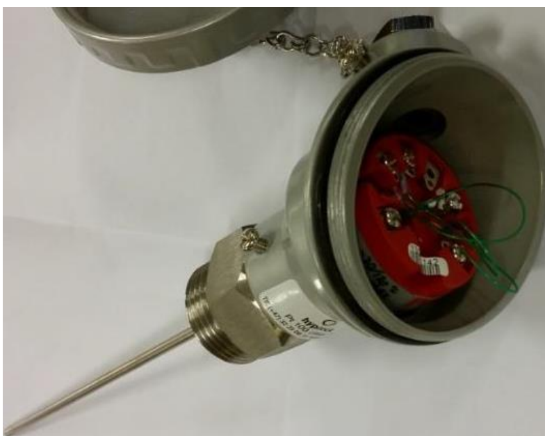
Figur 5: Temperaturmåler plassert på transformatorer i prøveprosjektet.
