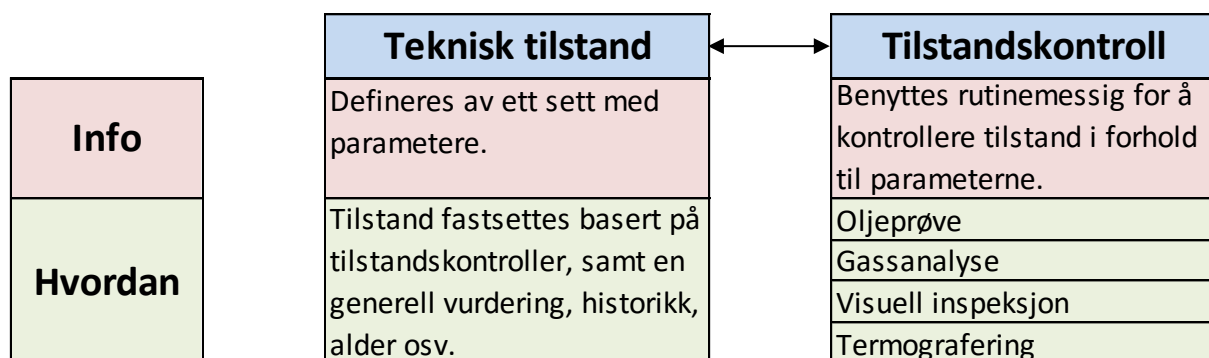
Figur 8: Enkel sammenheng mellom teknisk tilstand og tilstandskontroll
