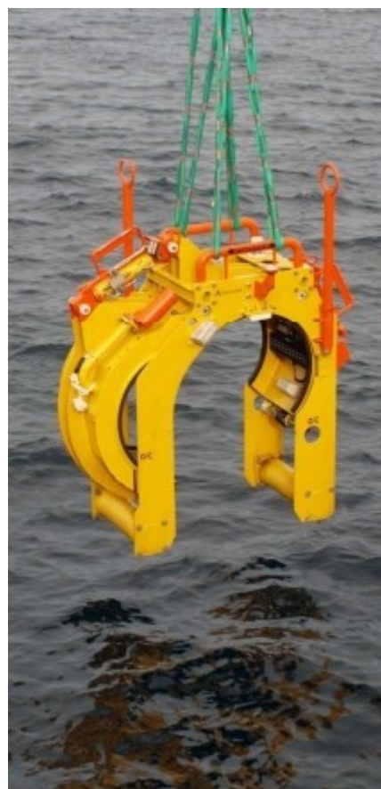
Figur 4-13: Ultramonit klargjort til installasjon på rørlinje. ( www.sensorlink.com )
