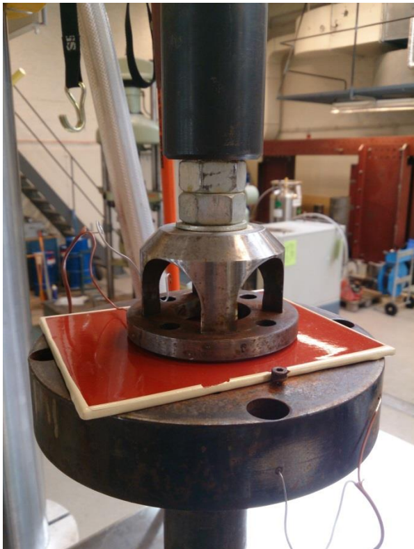
Figur 21: Testrigg – En beleggspørve (Belegg A) presses mot iscella
