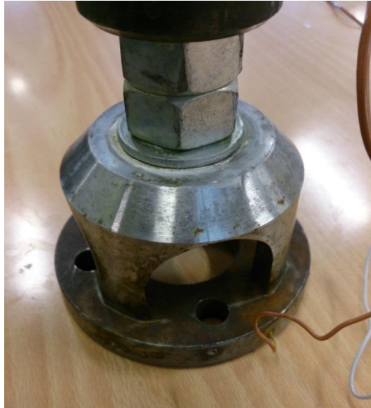
Figur 23: Testrigg - Iscella sett ovenfra med påfyllingshull for vann
