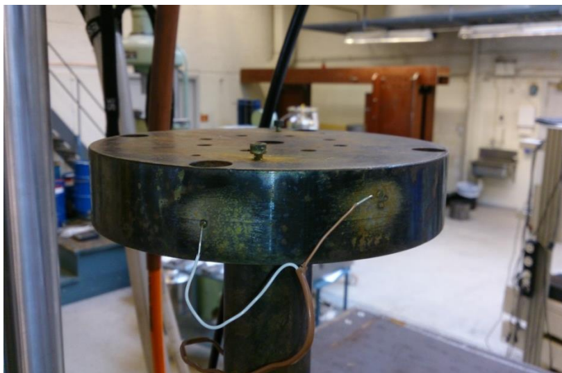
Figur 25: Testrigg - Prøveholder med termoelement for temperaturkontroll
