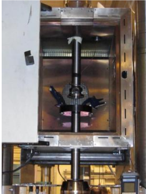
Figur 26: Oppstilling av testrigg med oppmontert kjølekammer (38)
