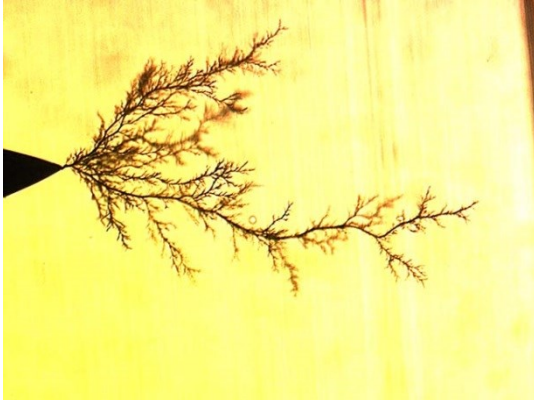
Bilde 3-1: Elektrisk tre som vokser ut fra en nål-elektrode.
