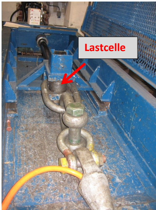
Bilde 4-2: Innfestning i strekkbenk med hydraulikksylinder.
