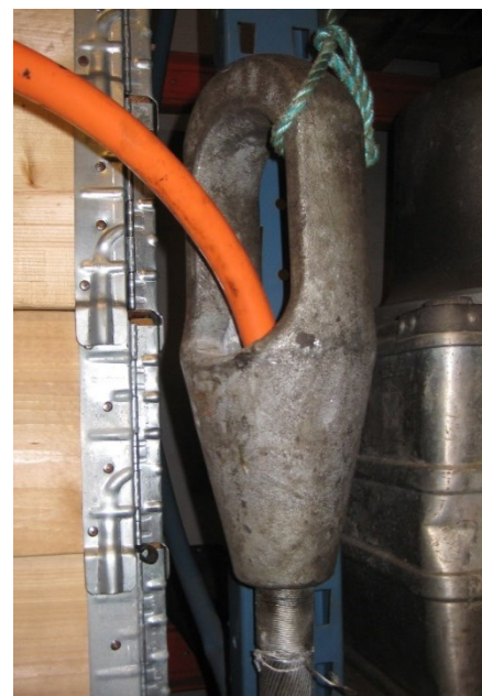
Figur 4-5: Socket klargjort for støping, tape i bunnen av socket mangler.
