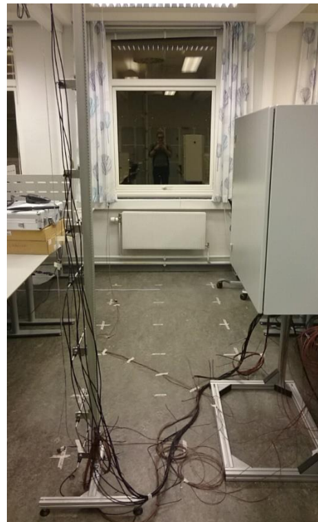
Figur 4.4: Måleutstyret i bruk. Her vart det gjennomført ei måling tre meter inn i rommet. Skapet til høgre i biletet innehaldt loggeutstyr.
