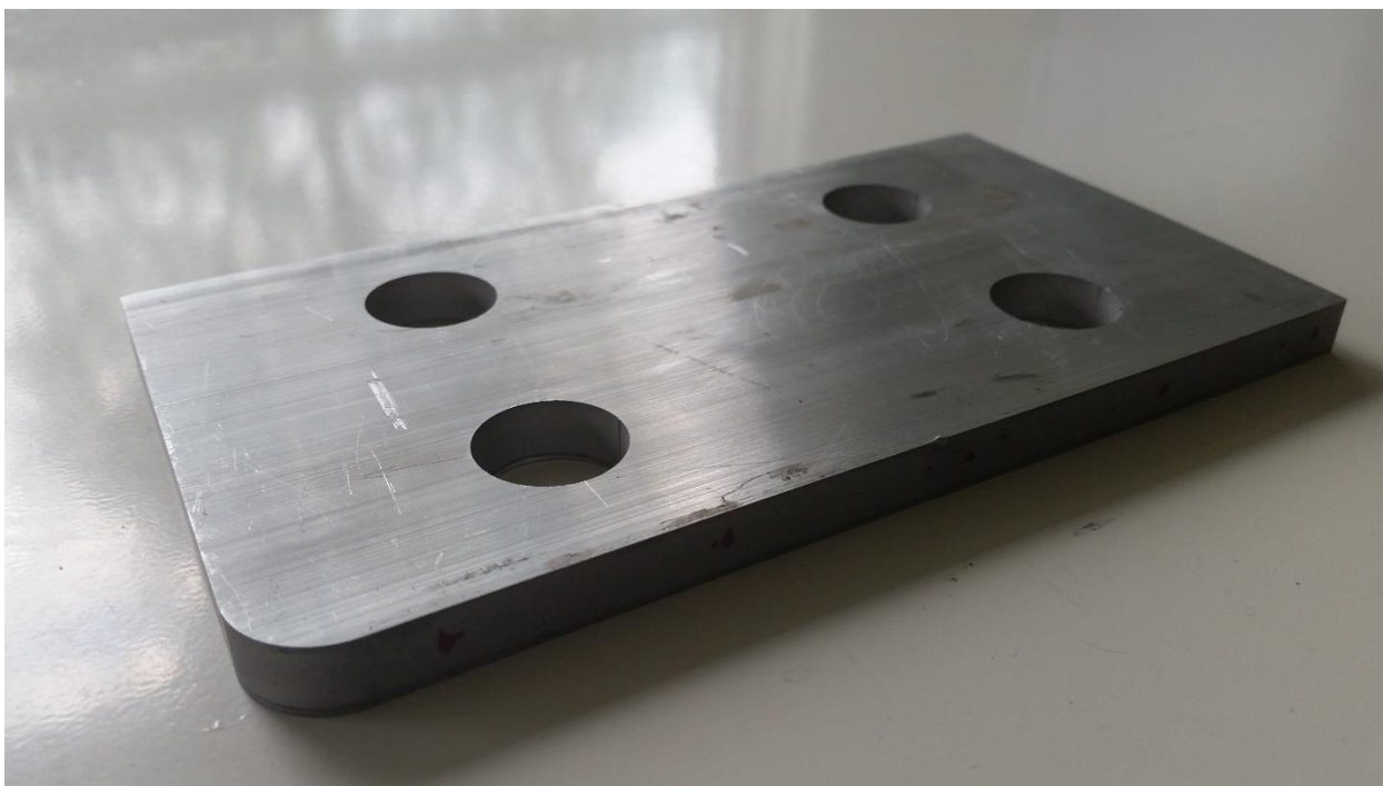
Figur 27: Topplate som skal inspiseres i koordinatmålemaskin.
