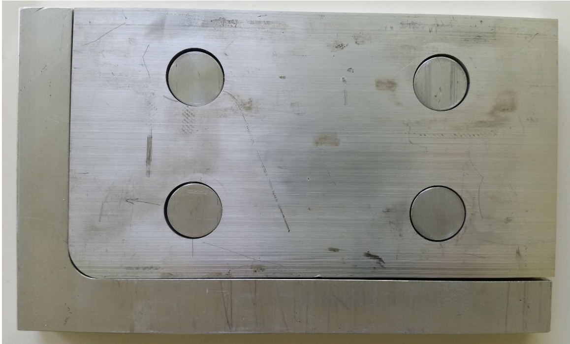
Figur 35: Sammenstilling av topplate og funksjonstolk. Delene passer sammen med knappest mulig margin.
