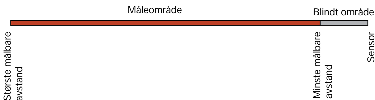
Figur 35 – Illustrasjon av måleområdet til infrarød sensor
