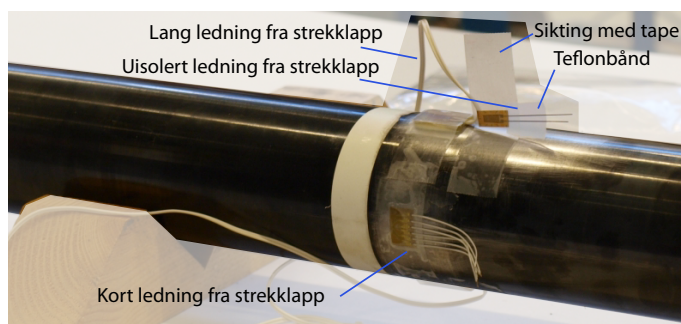
Figur 40: Siktemetode for riktig plassering av strekkklapp.
