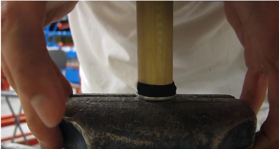
Figur 36 Utvidelse av gummikloss
