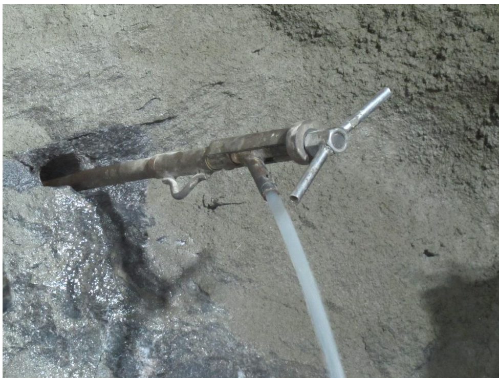
Figur 4.1. Bildet viser en injeksjonsstav med pakker som brukes til måling av innlekkasje
