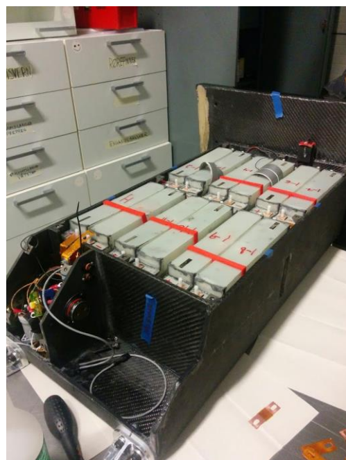
Figur 97 Batterikassen og dens moduler
