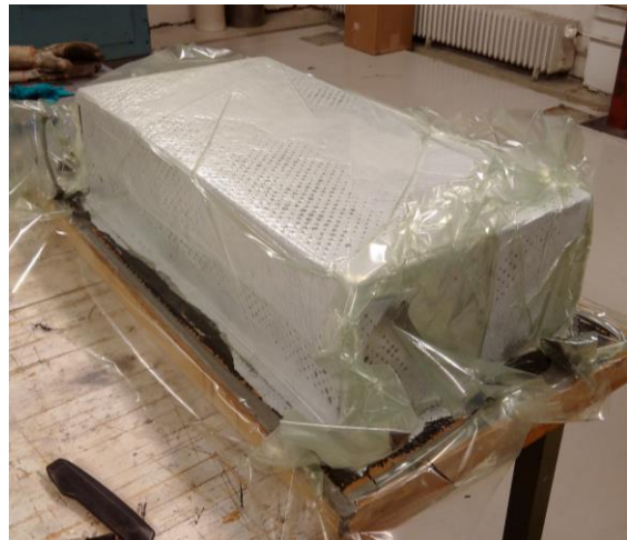
Figur 87 Ferdig herdet batterikasse etter å ha vært i ovnen
