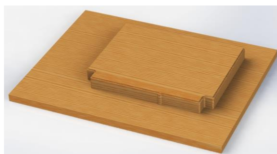
Figur 94 Støpeform til topprom
