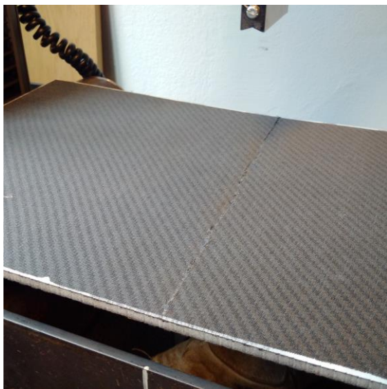
Figur 72 AB01, brudd langsmed lastapplikatoren
