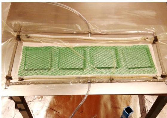
Figur 42 Vakuuminfusjon av AP06-AP09
