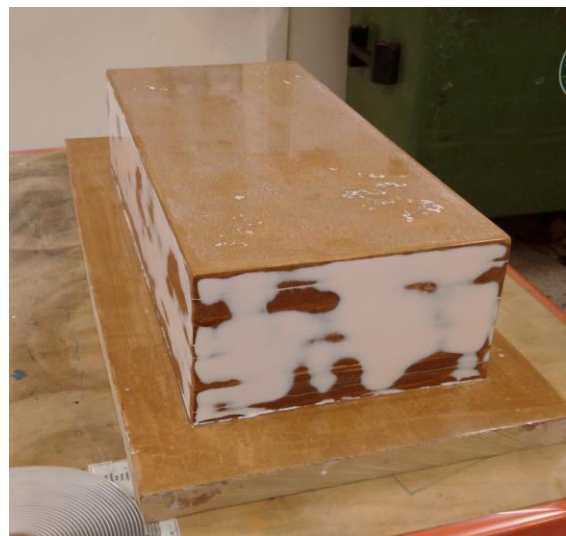
Figur 86 Batterikassens støpeform klar for støp
