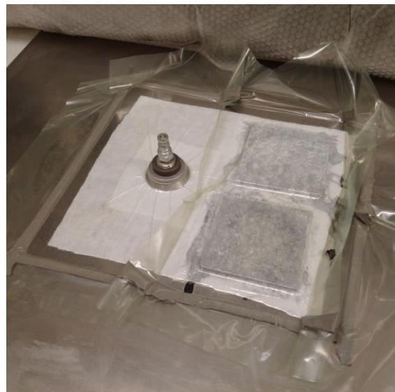
Figur 53 Testpanelene AP10-AP11 under vakuum
