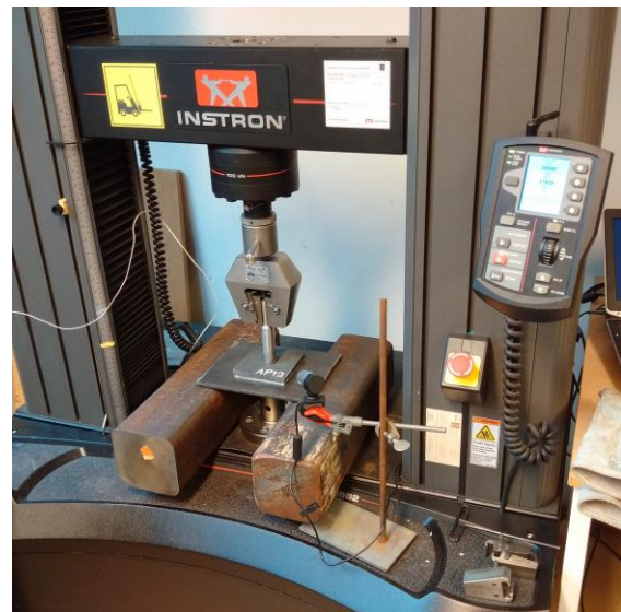
Figur 31 Instron® 5982 med penetrasjonstest-oppsett av AP12
