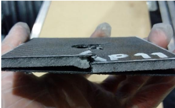
Figur 58 AP11, delaminasjon og brudd
