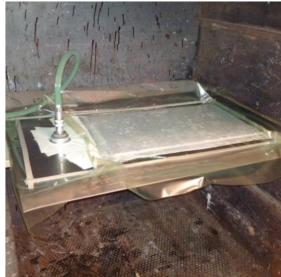
Figur 68 AB01 i ovn under vakuum
