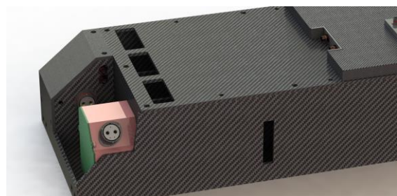
Figur 14 Innluft hull på lokket og på langsiden
