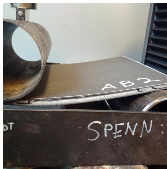
Figur 78 AB02, nærbilde av brudd mellom lastapplikator og høyre opplagring
