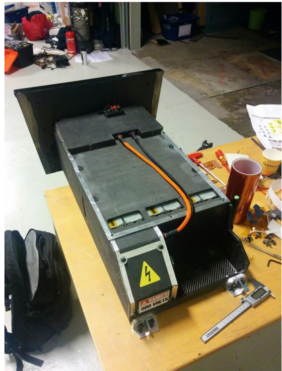
Figur 95 Ferdig montert batteripakke
