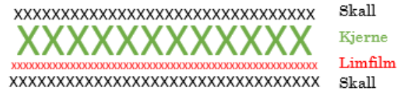
Figur 52 Snitt av AP10 og AP11 sin lay-up
