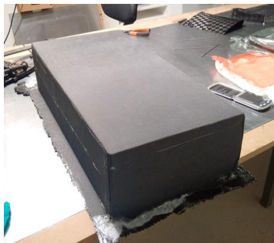
Figur 89 Utsiden av batteriboksen
