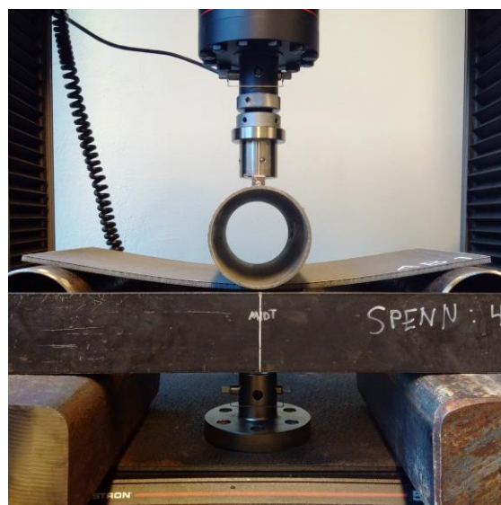
Figur 70 AB01 ved 25,4 mm forlengelse av lastapplikatoren
