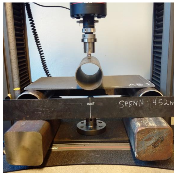
Figur 69 AB01 innspent til test
