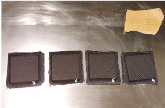
Figur 44 AP06-AP09, ferdig støpt, øvre skall
