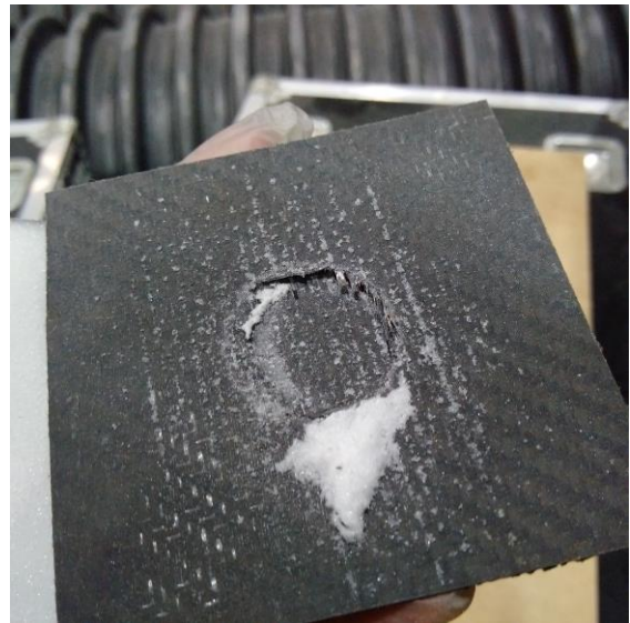
Figur 60 AP11, kjerne-materialestøv på nedre skall
