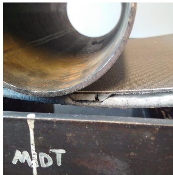
Figur 77 AB02, nærbilde av brudd ved lastapplikator
