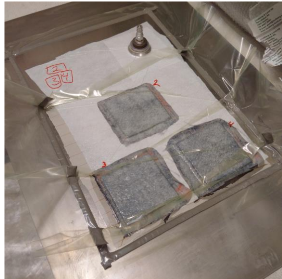
Figur 61 Vakuumbagging av AP12-AP14
