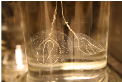
(c) Fuktprøver i 90°C vannbad 30 s etter veiing
