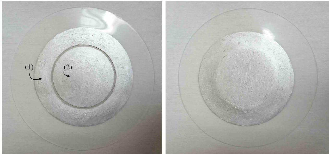
(a) Forside av prøveobjekt. (1) Kontaktområde for guard, (2) Kontaktområde for måleelektrode. (b) Bakside av prøveobjekt med påmalt kontaktområde for høyspentelektrode
