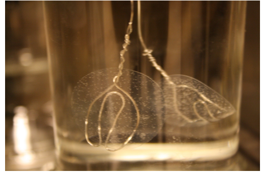
(b) Fuktprøver i 90°C vannbad umiddelbart etter veiing
