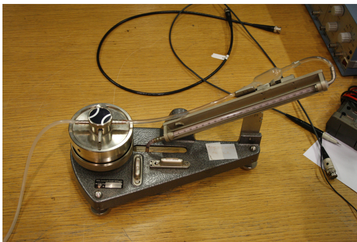
Figur 4.1: Kalibrering av differansetrykkcelle
