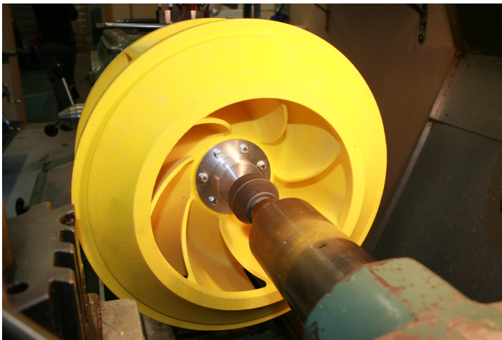
Figur 3.1: Løpehjul oppspent for kastkontroll
