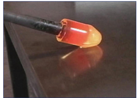
Puntel med litt smeltet glass i enden
