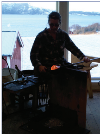
5. Glasset vekselvis formes og varmes til det har fått ønsket form.
