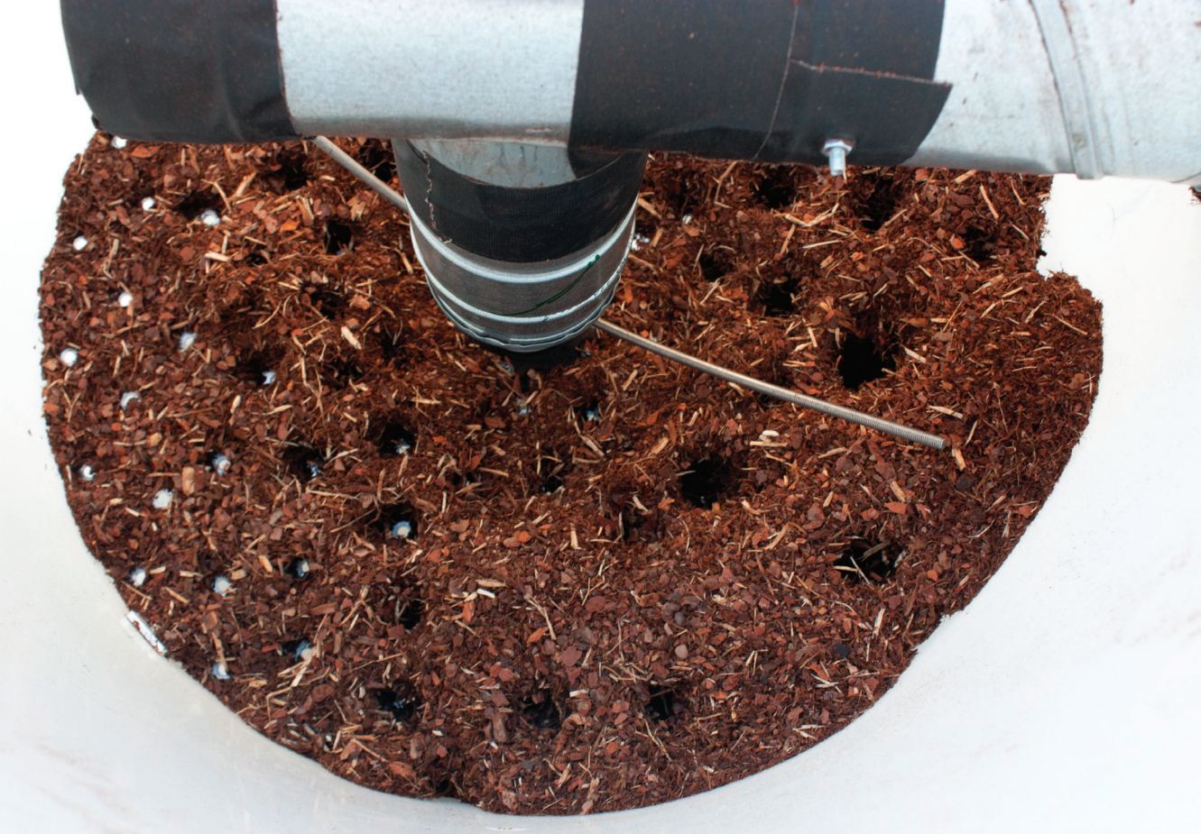
Bildet over viser et typisk problem der luften graver små luftkanaler
