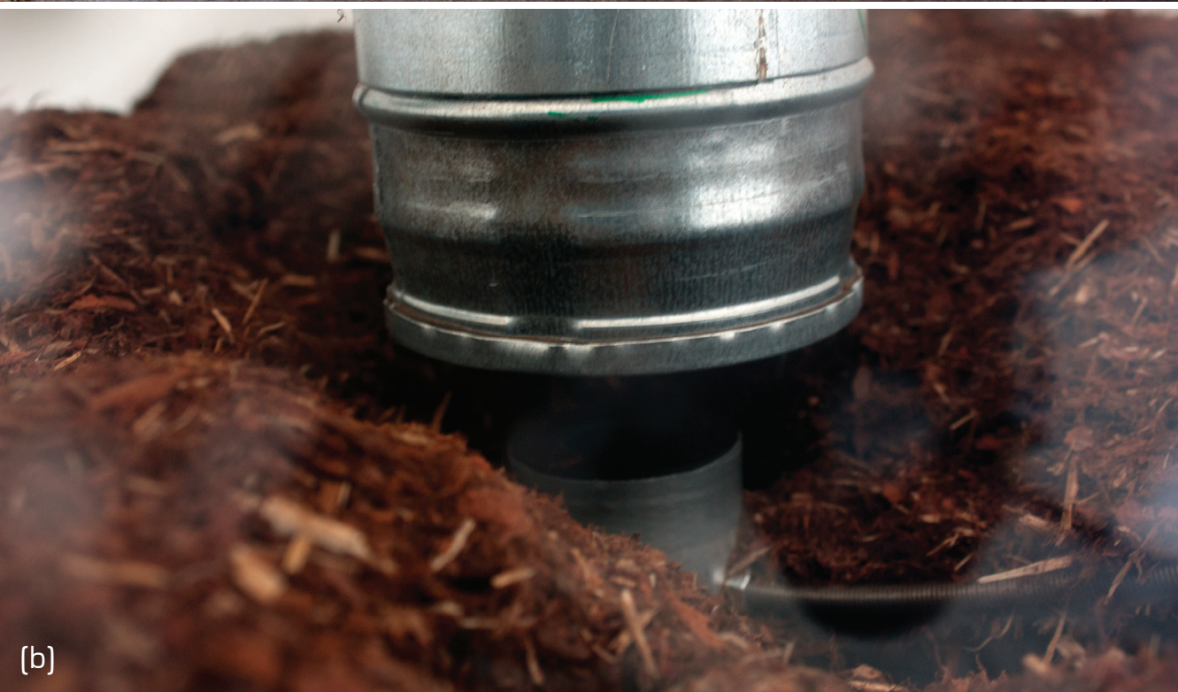
Bilder fra testgjennomkjøringene. (a) Prototypen tilkoblet MOSE sugeenhet, (b) Kontroll av rørestag gjennom vindu i sorbenttanken
