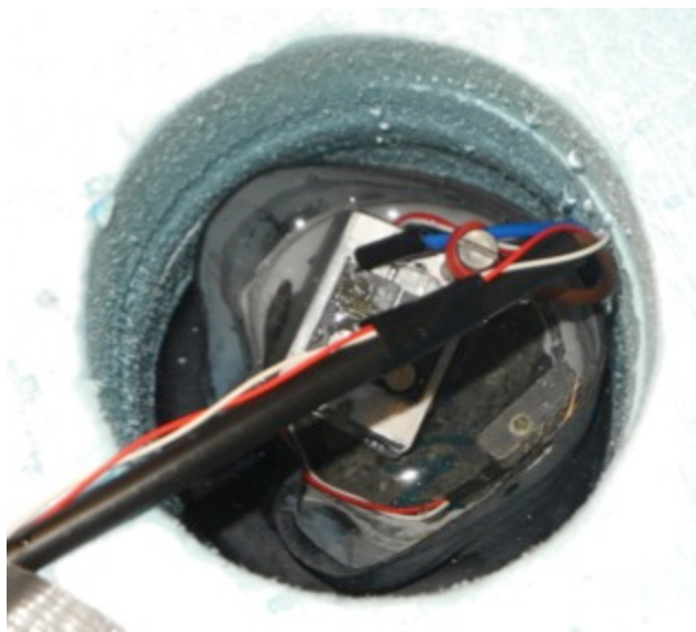
Figur 19 Sett ovenfra og ned. Varmeelement med termostat. 15-20mm vannbad. Foto: Maren Kristine Tandberg
