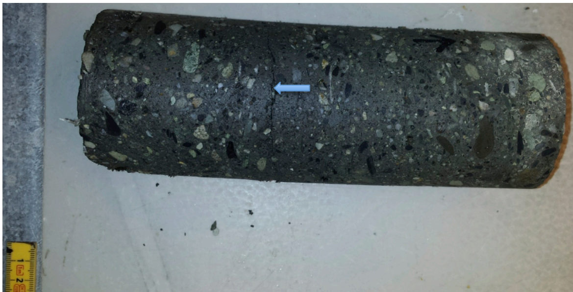
Figur 39 Kjerneprøven fra ASTM C666 etter 97 fryse/tine-sykler som har fått en tydelig sprekk på midten. Foto: Maren K Tandberg
