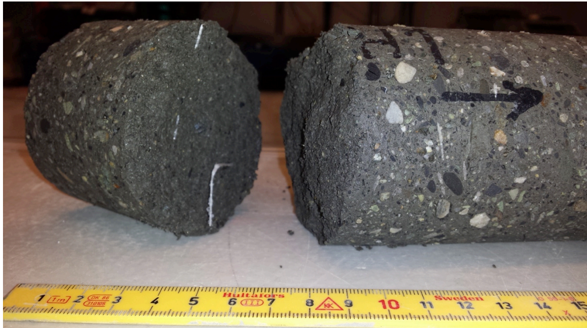
Figur 37 Etter 59 fryse/tine-sykler hadde en av kjerneprøvene, i ASTM C666, delt seg i 2. Foto: Maren K Tandberg
