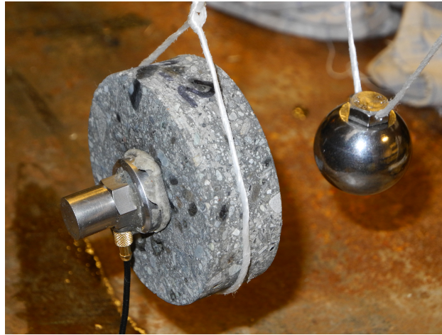
Figur 31 Oppsett: betongdisk med sensor hengende i en snor. Kule i stål hengt opp til å treffe senter av disken. Foto: Maren Kristine Tandberg
