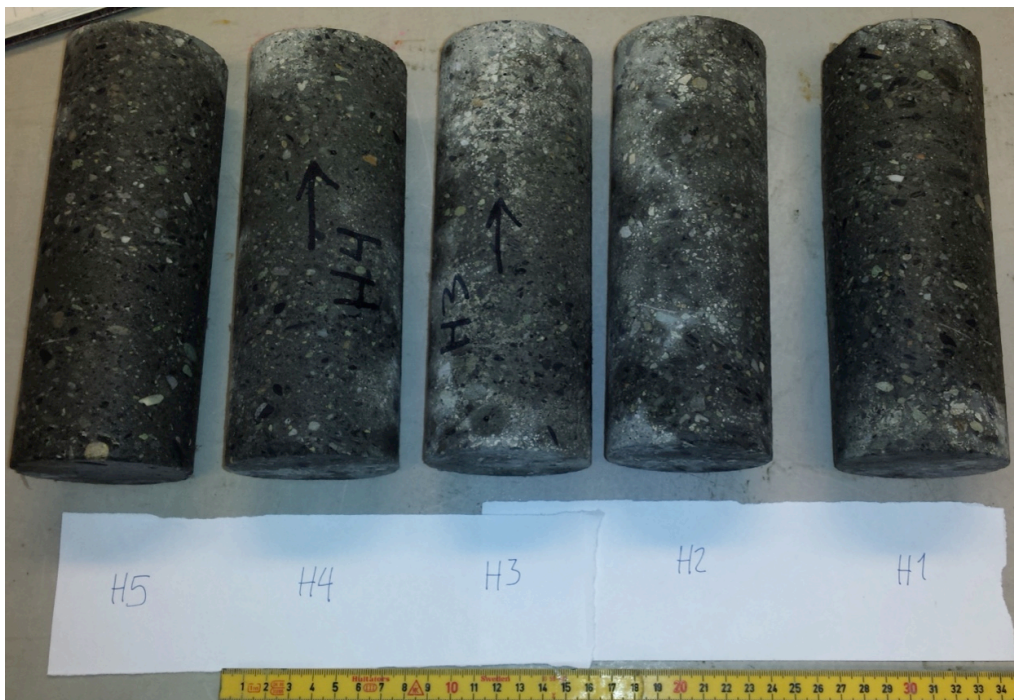
Figur 36 Kjerneprøvene fra ASTM C666 etter 42 fryse/tine-sykler. De to kjerneprøvene som er lengst til høyre og venstre er mer fuktige enn de andre etter like lang tid på benken. Foto: Maren K Tandberg
