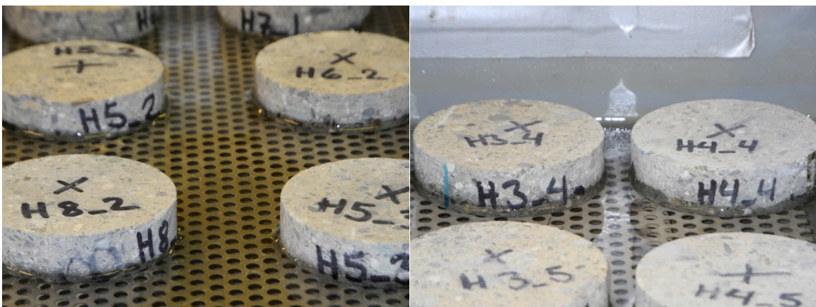
Figur 23 Kapillær absorpsjon. Disker lagt på en rist fylt med ca. 1mm vann over rista. En tydelig vannkant kan sees på betongen. Foto: Maren Kristine Tandberg
