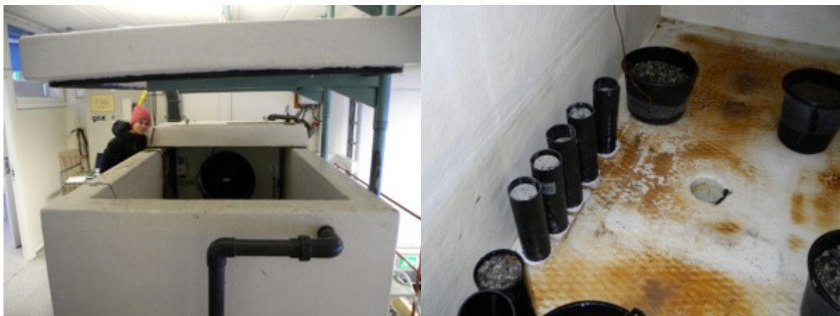
Figur 11 Til venstre: Apparaturen som regulerer temperatur og vann i ASTM C666 utført på SINTEF. Til høyre: Oppi apparaturen. Til venstre: Vann fylles opp til over beholderne som prøvene står i og blir så fjernet slik at det kun er 3mm vann rundt prøvene og ikke utenfor beholderne. Beholderne er laget til av Karl Gunnar Holter for akkurat dette forsøket. Foto: Karl Gunnar Holter
