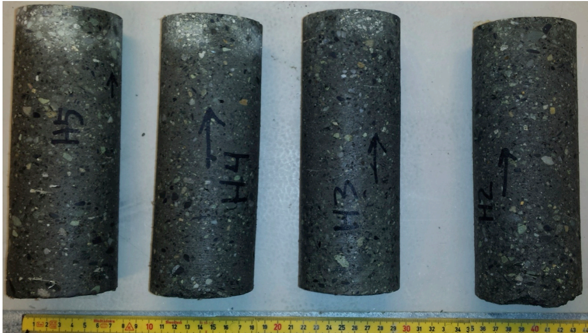
Figur 38 Kjerneprøvene fra ASTM C666 etter 97 fryse/tine-sykler. Kjerneprøven lengst til venstre har en tydelig sprekk, se neste figur. Foto: Maren K Tandberg
