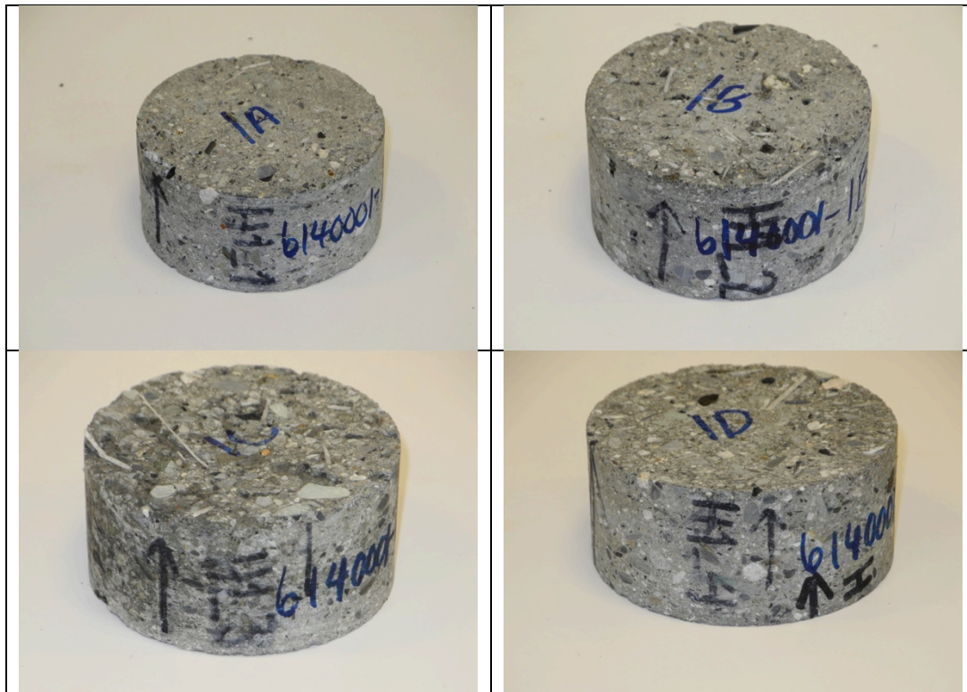
Figur 43 Kjerneprøver gjennomgått 56 fryse/tine-sykler iht. Borås testmetode med kun vann som væske på toppen. Foto: Karl Gunnar Holter
