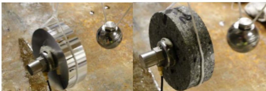
Figur 20 Til venstre: Kalibreringsoppsett. Til høyre: Oppsett med betongdisk. Foto: Maren Kristine Tandberg
