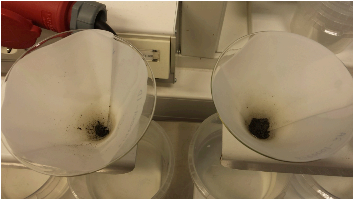
Figur 42 Betongavskalling i filterpapir etter 14 dager. Til venstre sees avskalling fra en prøve utsatt for kun vann og til høyre avskalling fra en prøve utsatt for 3% saltløsning. Foto: Maren K Tandberg
