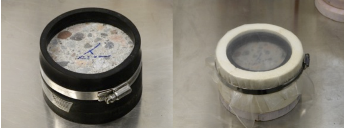
Figur 14 Til venstre: Oppsett med kun gummi. Til høyre: Oppsett med gummi, isolering og plastfilm. Foto: Maren Kristine Tandberg
