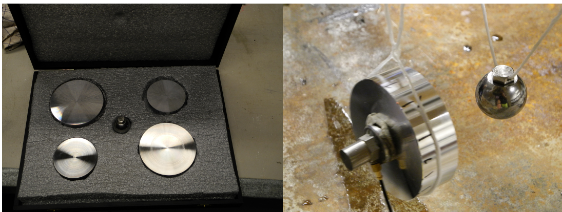
Figur 32 Til venstre: Kalibreringsutstyr i form av disker i aluminium og stål, og stålkula. Til høyre: Oppsett med ståldisk. Foto: Maren Kristine Tandberg
