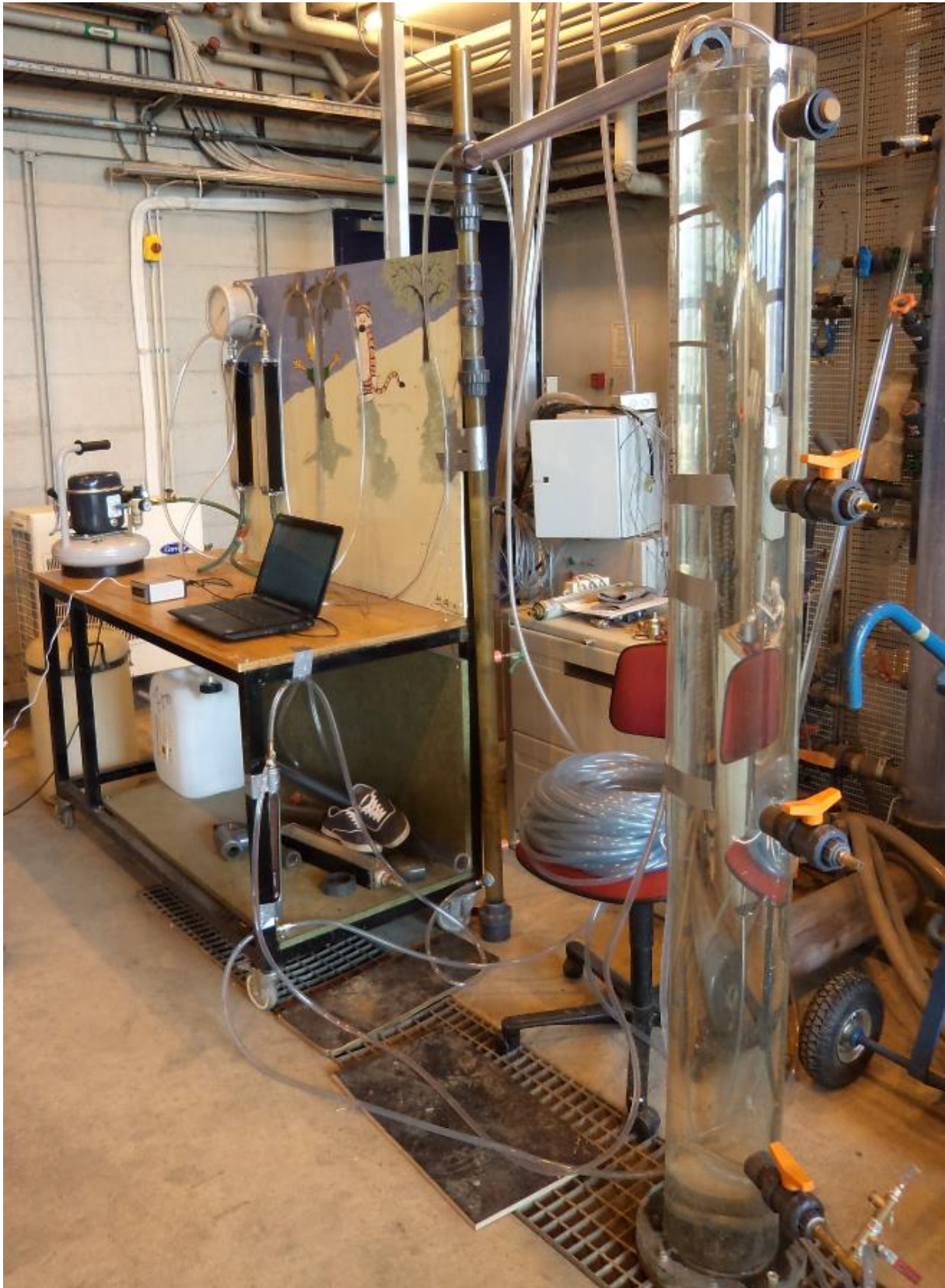
Figur 13: Bilde av modellen, med gasstilførsel til venstre, produksjonsrør i midten og vanntilførsel til høyre.
