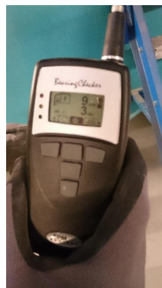
Figur 26 Lagerstøy i bakre lager på røykgassvifte
