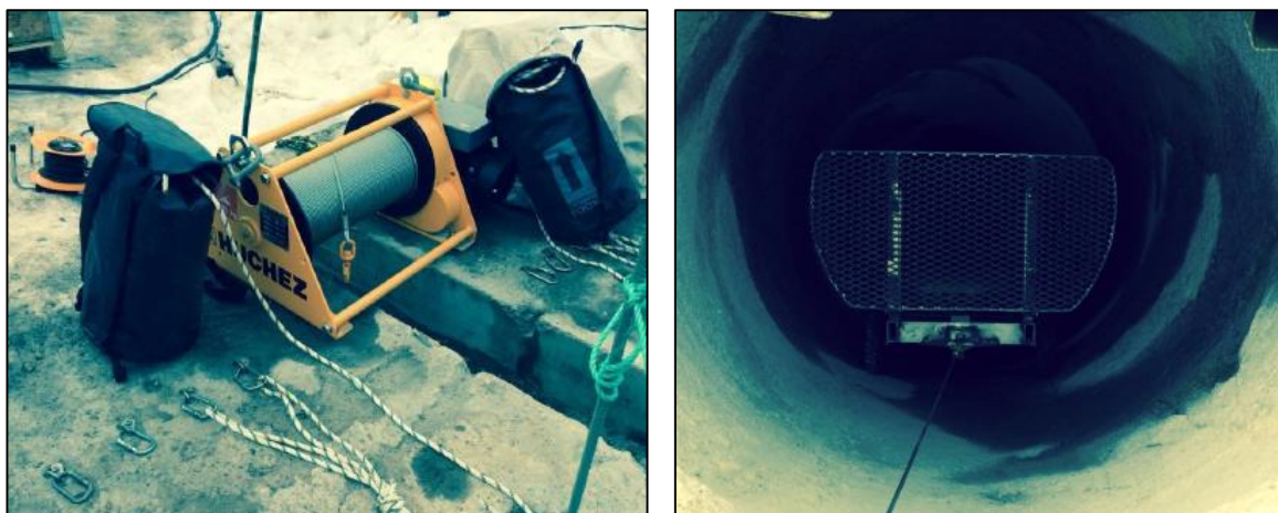
Figur 9. Til venstre vises innfestingen til klatretau og vire. Til høyre er vognen sett ovenfra. Foto: Implenia
