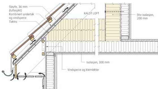
Figur 5.3 d Eksempel på omgjøring til kombinert undertak og innvendig etterisolering med 50 mm påføring. (Illustrasjon: Bøhlerengen, 2009)
