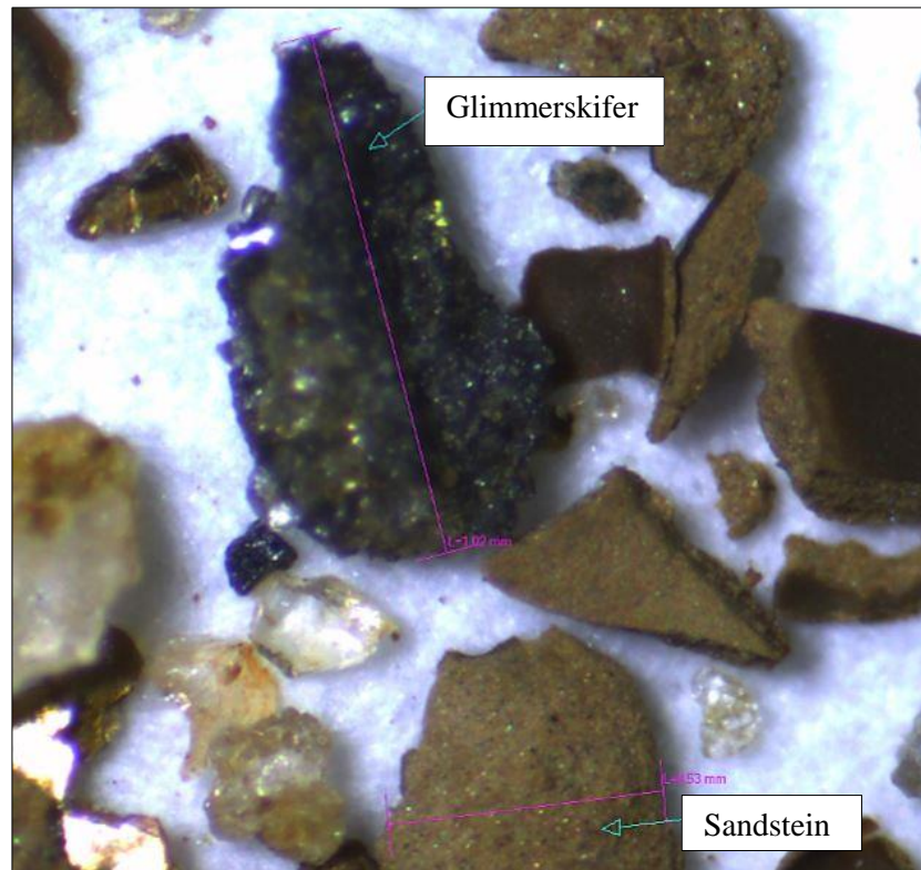
Figur 5.11 En stor andel bueformete fragmenter med "fastkittet" sandstein rundt ble observert i mikroskopet. Bildet viser innsiden av kornet som består av en svart hinne og har en lengde på 0,65 mm og tverrsnittet av et annet fragment, lengde 0,12 mm. Forstørret bilde av figur 5.9 og figur 5.10 finnes i vedlegg B. Foto: Bjørge Brattli.
