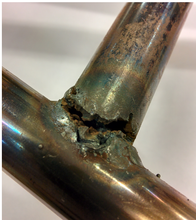
Figur 2.11: Bruddet i den nedre bæreamen (undersiden av armen)
