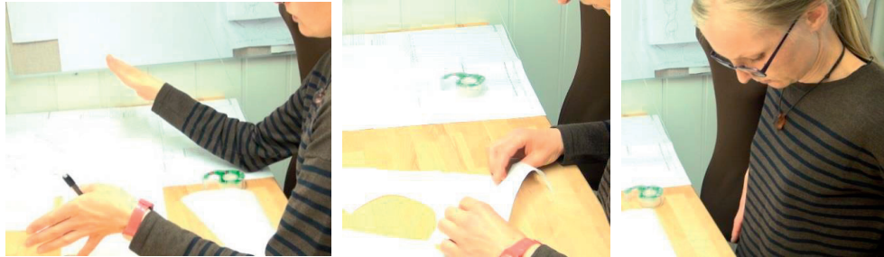
Figur 72 Billeder fra mønsterkonstruktionen, hvor jeg forsøger at give beregningerne en konkret forankring ved henholdsvis at folde papiret til form, bruge hænderne til at forstå hvordan mønsterdelene splittes op, samt måle på kroppen
