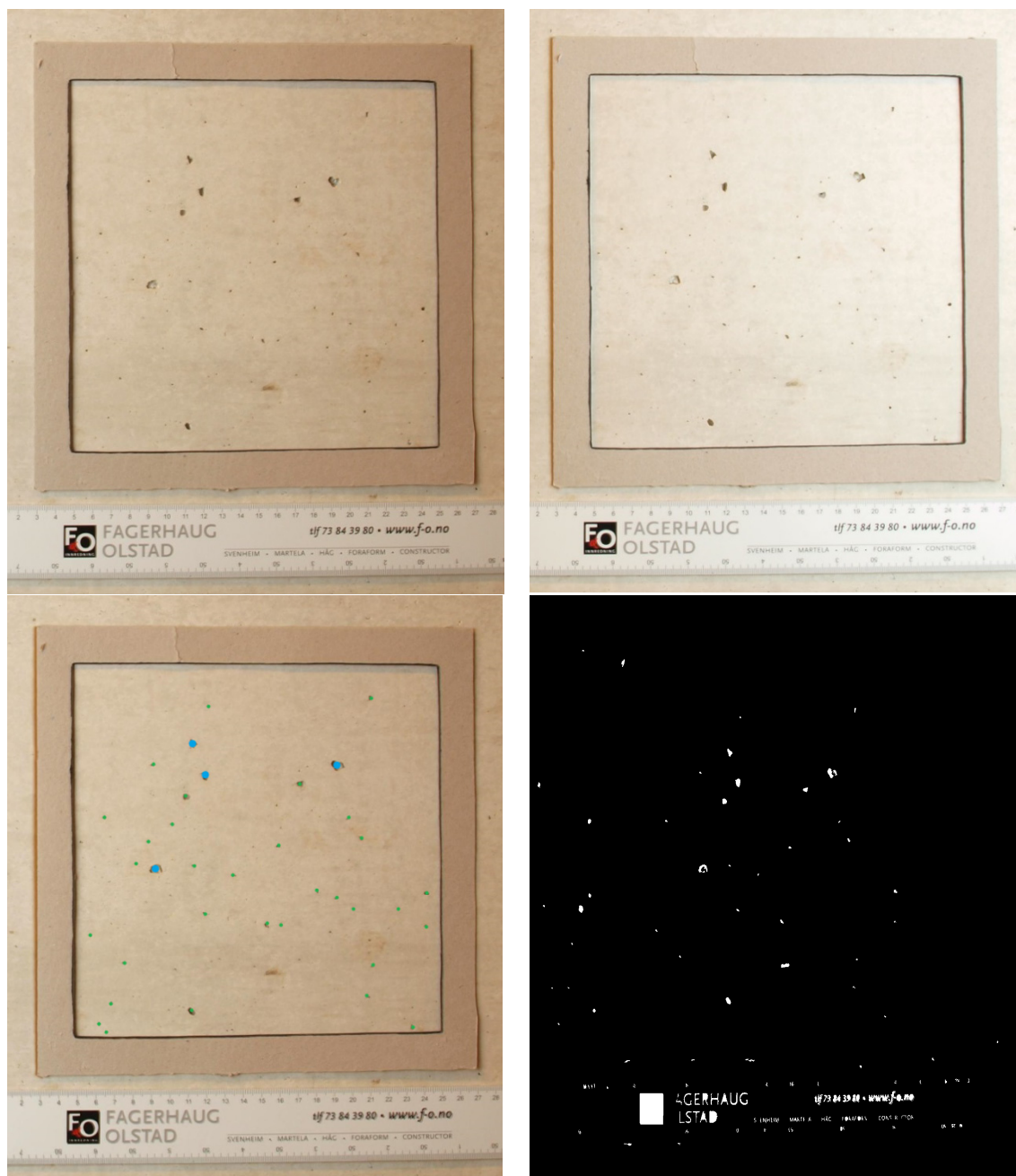
Figur 2.4 b Øverste rekke: Bildene er zoomet inn 20x20 cm med blits fra venstre og høyre. Nederste rekke: Manuel telte porer i forskjellige poreklasser med fargekode (grønn = 1–5 mm, blå = 5–10 mm, rød = 10–15 mm) på kombinerte bilder (venstre) og analysert med BetongGUI (høyre)
