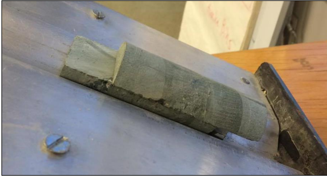
Figur 3.12 Den ene halvdel av kjernen sklir over den andre når friksjonsvinkelen nås (Foto: Erlend Alvestad).
