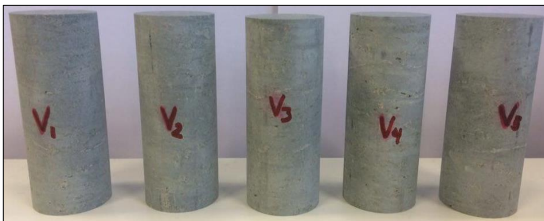
Figur 3.10 Fem kjerneprøver for testing av enaksial trykkfasthet fra det vestlige området (V1-V5) (Foto: Erlend Alvestad).
