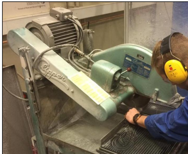
Figur 3.6 Saging av kjerneprøver i riktige lengder (Foto: Erlend Alvestad).
