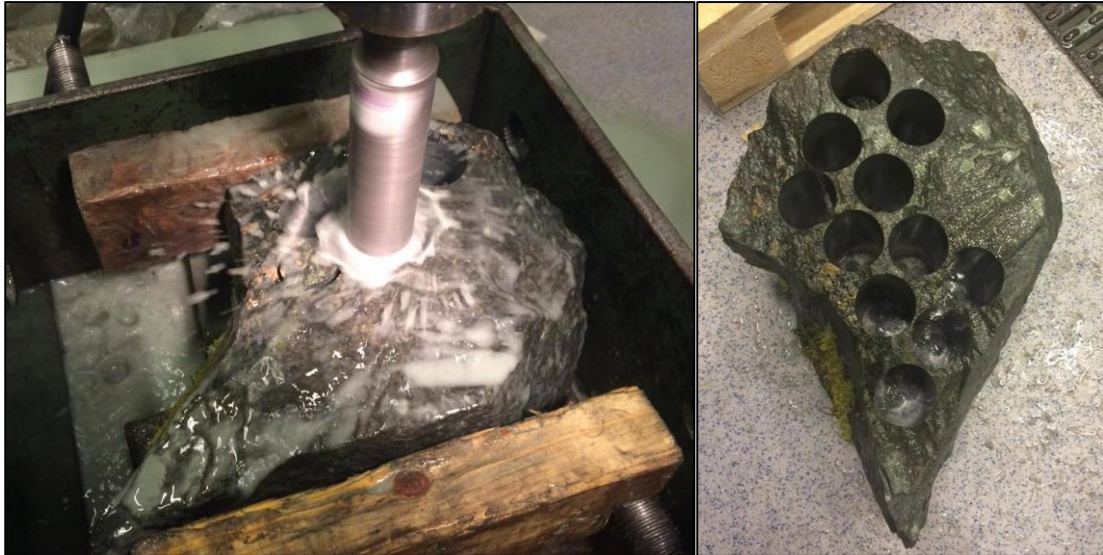
Figur 3.5 Boring av kjerner fra blokkprøvene i laboratoriet (Foto: Erlend Alvestad).
