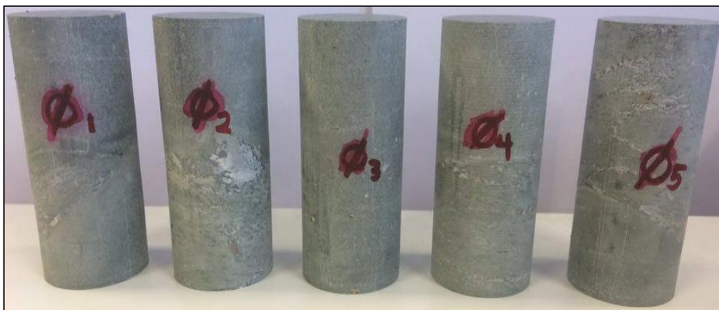
Figur 3.9 Fem kjerneprøver for testing av enaksial trykkfasthet fra det østlige området (Ø1-Ø5) (Foto: Erlend Alvestad).
