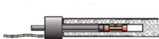
Figur 5-7: Andre avlesning etter at kjernen er tatt ut av borhullet (SINTEF, 2005).
