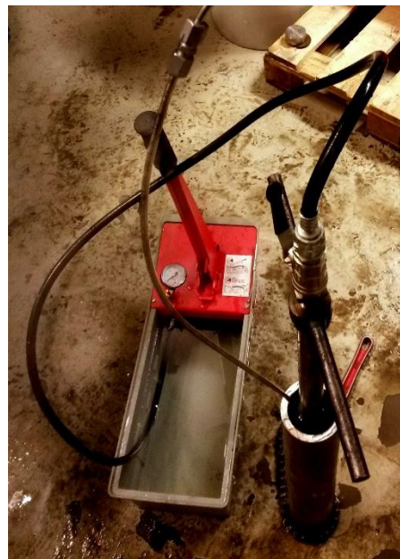
Figur 8-6: Trykktesting av utstyret i «borhull» med vannpumpe (Foto: Stine Merete Moe).
