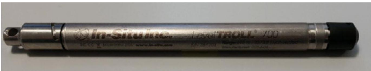
Figur 8-1: Trykksensor med datalogger som ble brukt til å registrere trykket som ble tatt opp av «flat-jack» i borhullet (Tunbridge, Aasrset og Tønnessen, 2014).
