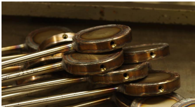
Figur 8-3: «Flat-jackene» med boret og gjenget hull (Foto: Helene Strømsvik).
