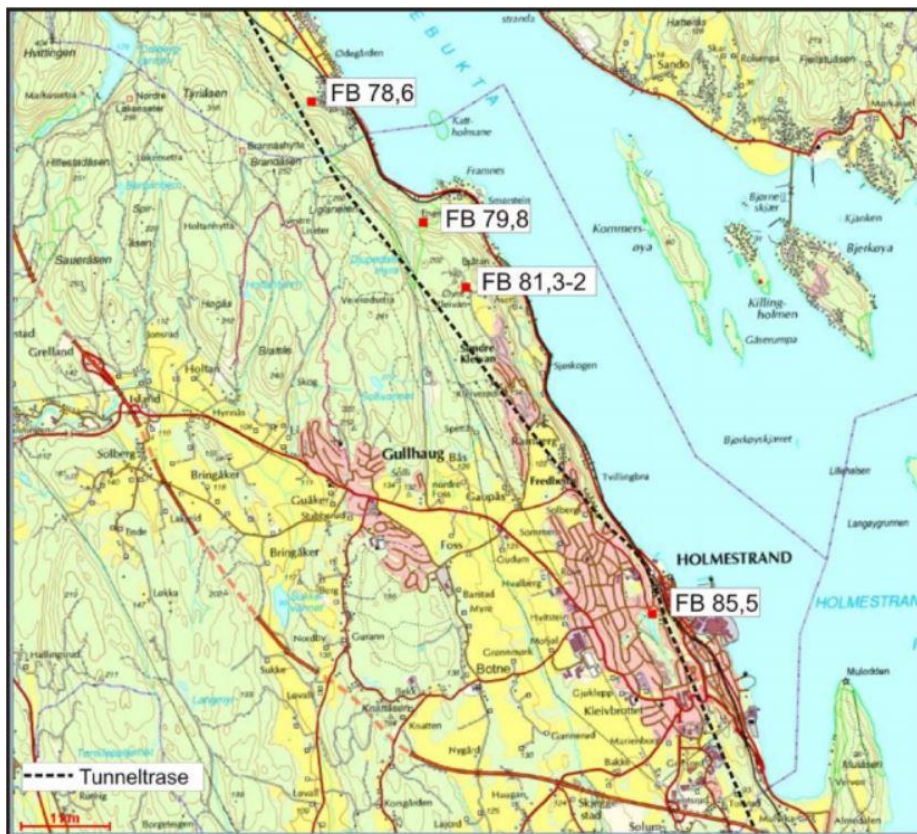
Figur 7-13: Plassering av fjellbrønnene for overvåking av grunnvannet i forhold til tunneltraseen (Elvebakk, 2010).
