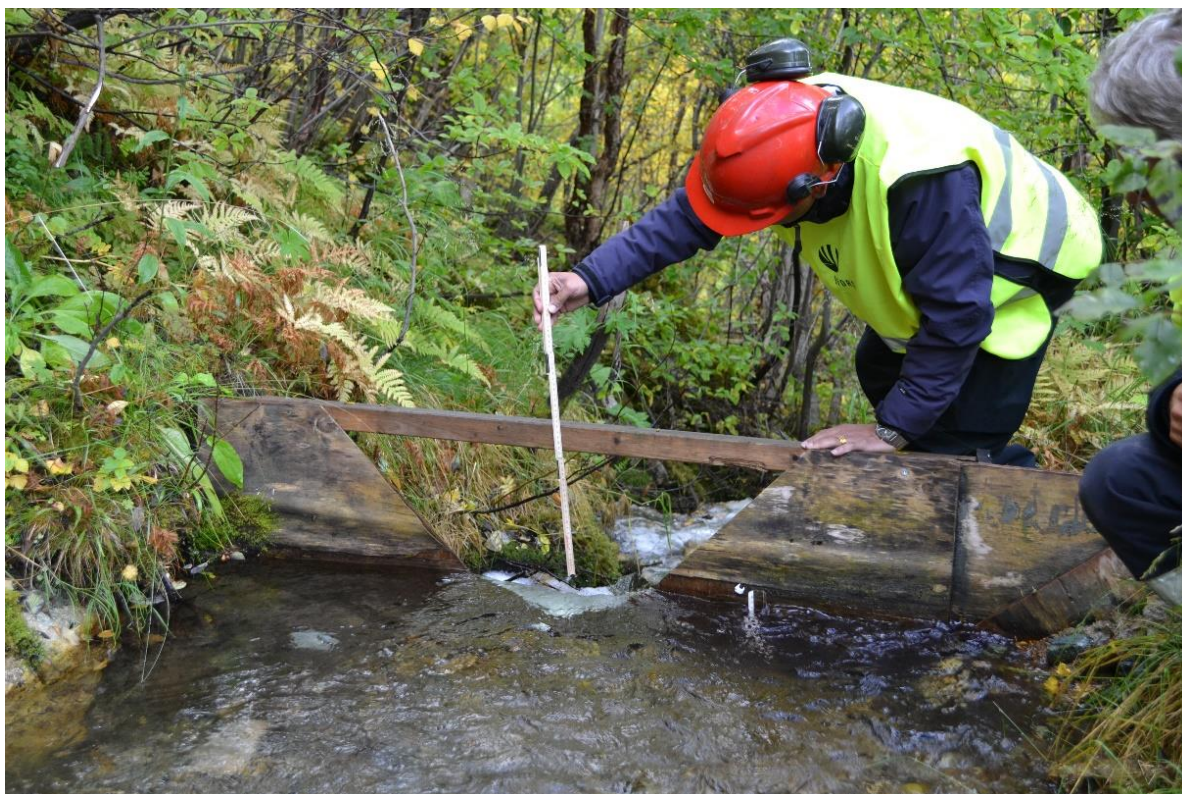
Figur 8-9: Veileder Krishna K. Panthi utfører måling av vannføring i etablert v-overløp. (Foto: Chhatra Bahadur Basnet)
