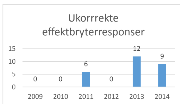
Figur 59 - Ukorrekte effektbryterresponser fra feilskriveropptak
