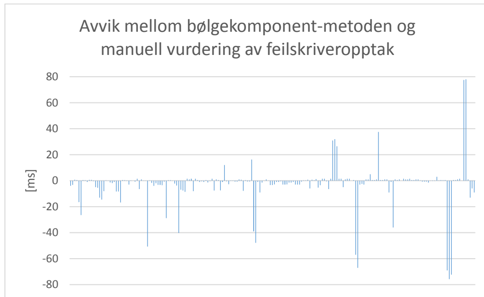
Figur 50 - Avvik mellom bølgekomponent-metoden og manuell vurdering av feilskriveropptak, uten de største avvikene
