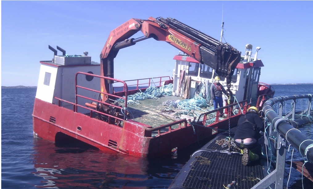
Figur 12 Løft av bunnring. Optimal/liten arm på kran.
