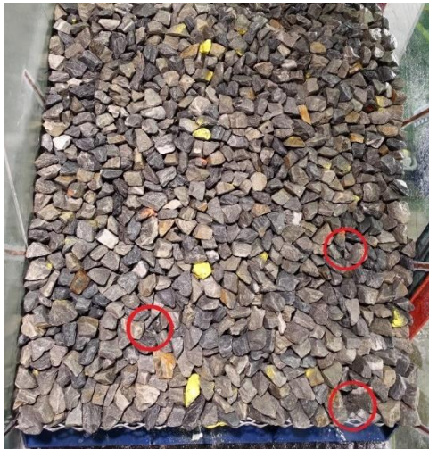
Figur IV-18 Modellforsøk 8 etter forsøk kjørt til 490 l/s.
