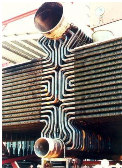
Figure 2-5 Inside of a large HRSG
