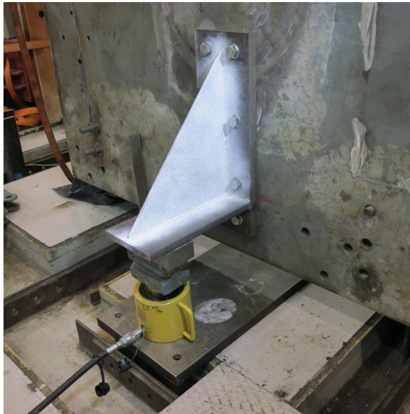
Figur 4.2.1: Oppsett av konsollforsøk
