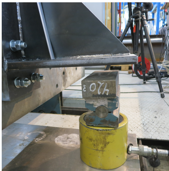
Figur 4.2.2: Nærbilde av lastpåføring
