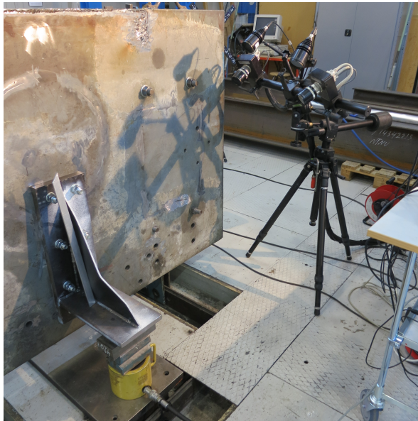
Figur 4.2.3: Kameraer benyttet i DIC
