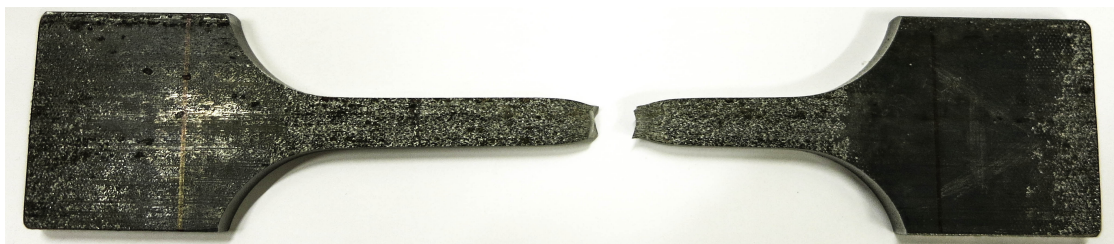
FIGUR 6.3: Materialprøve etter brudd
