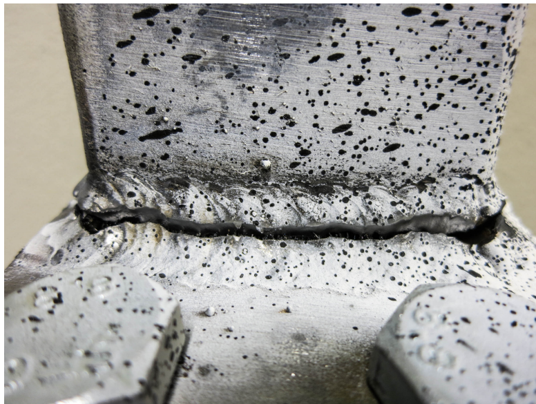
FIGUR 6.13: Brudd i sveis på prøvestykke A2, bilde fra "siden" relativt til kamera
