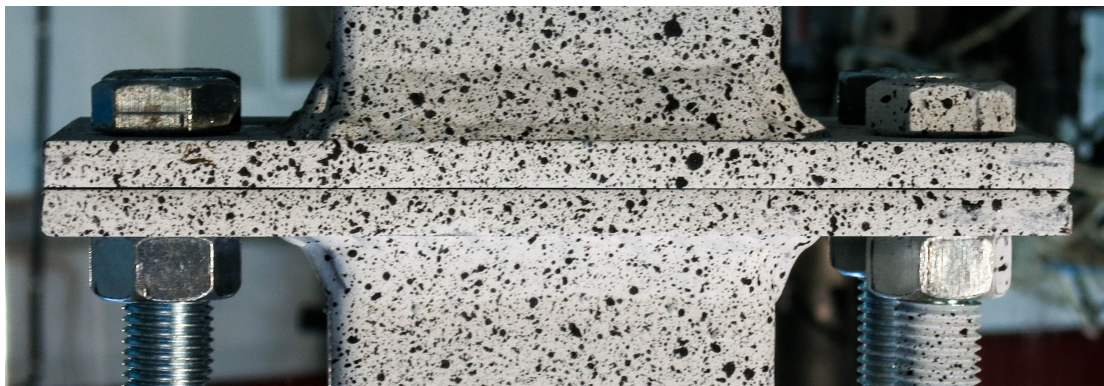
FIGUR 6.7: Prøvestykke A1 preparert med hvit grunning og spraylakkert med svart
