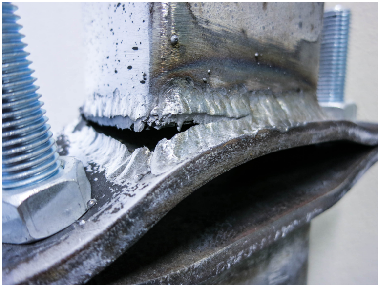
FIGUR 6.11: Brudd i sveis på prøvestykke A1, bilde fra "bakside" relativt til kamera
