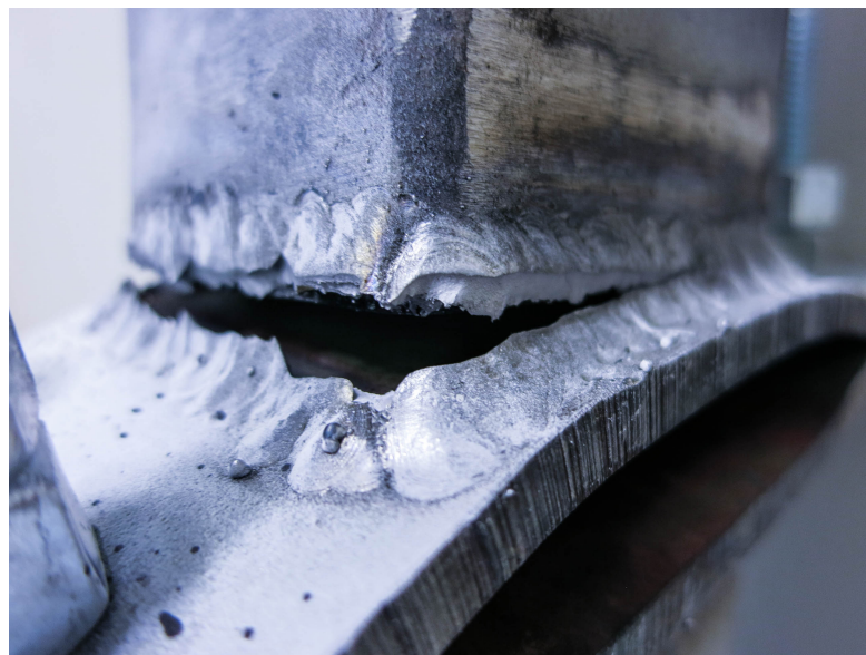
FIGUR 6.17: Brudd i sveis på prøvestykke B2, bilde fra "bakside" relativt til kamera
