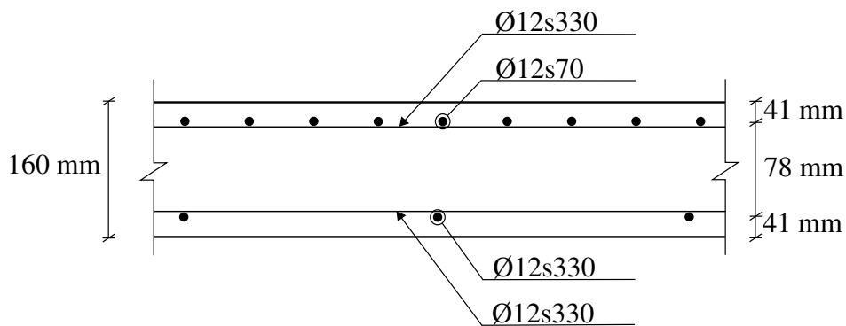
Figur 6.5: Armering for taket over støtte
