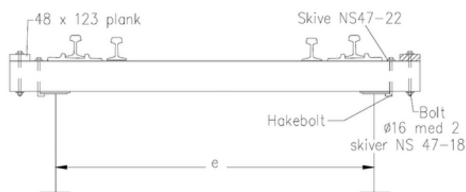
Figur 1-4: Innfesting sviller til brukonstruksjon [10]
